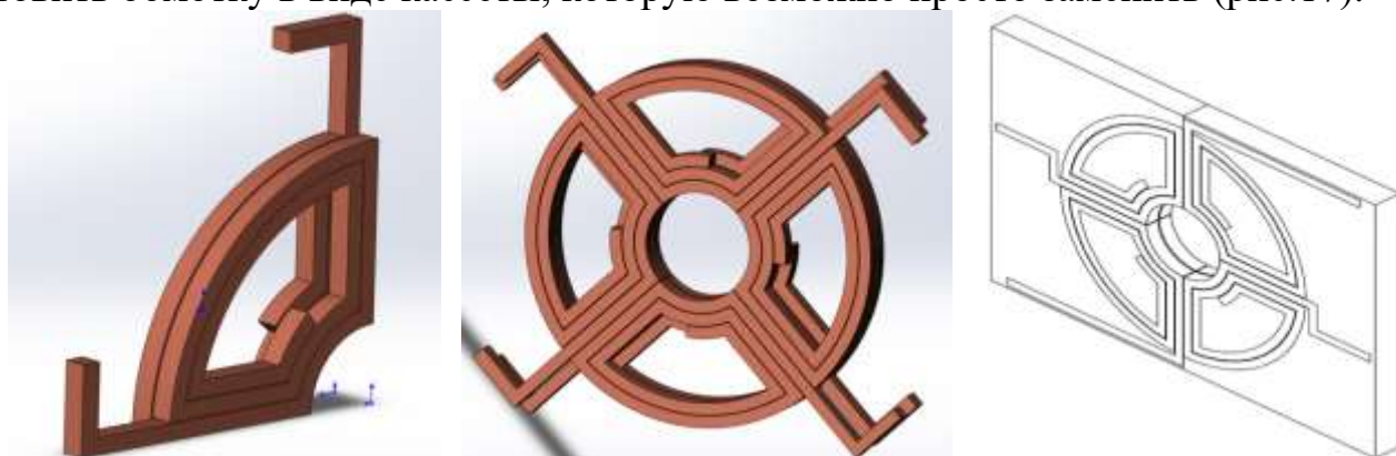
Рис.17. Конструкция обмотки кассетного типа
