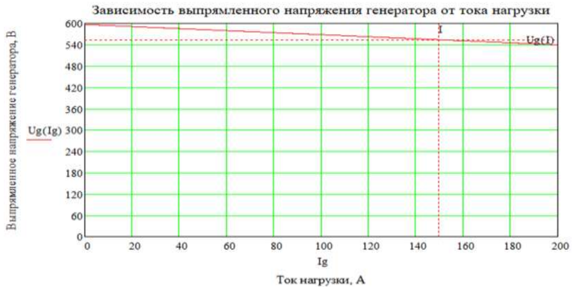
Рис.8. Внешняя характеристика генератора, построенная на основании разработанной методики расчета параметров генератора
