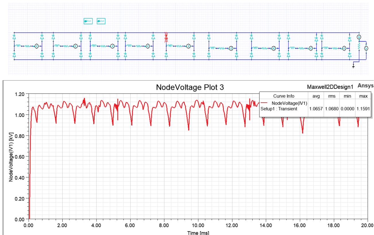
Рис.3.9.11. Схема и выпрямленное напряжение девятифазного полномостового выпрямление при соединении мостов в параллель при обрыве диода ( U_{cp}=1,065\text{кВ} , \Delta U=0, 2 )
