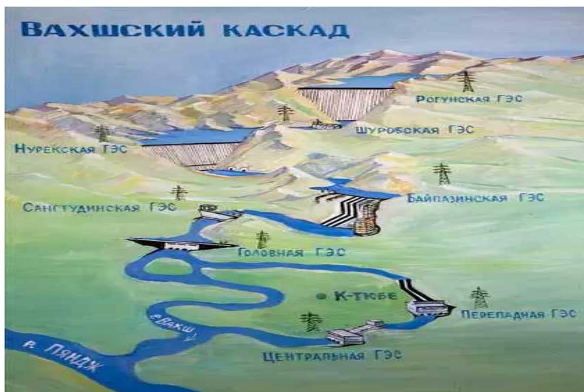
Рис. П.1. Вахшский каскад ГЭС
