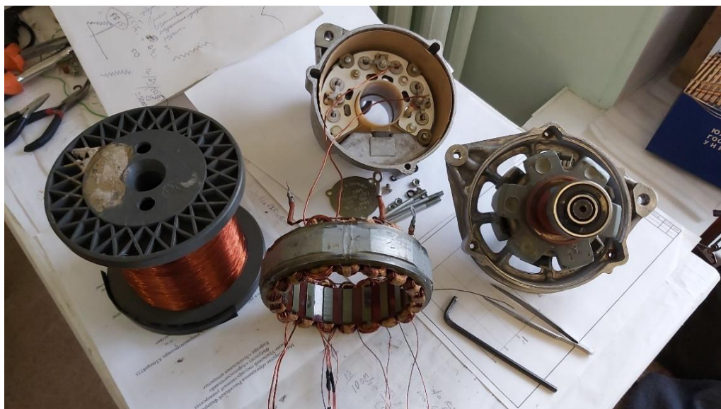
Рис.5. В.1. Основные части испытуемого генератора
