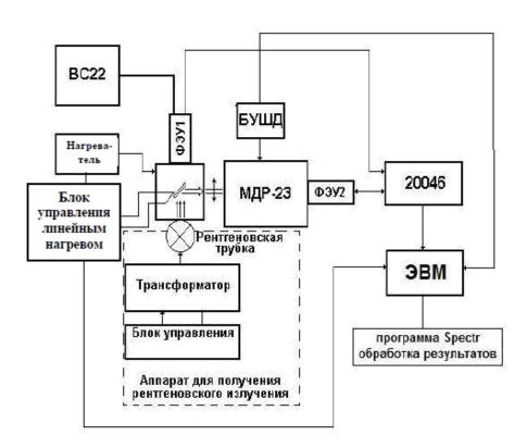
Рисунок 9.1 — Структурная схема установки для измерения термостимулированной люминесценции
