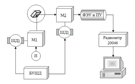
Рис. 9 — Блок-схема установки для измерения спектров ФЛ и ВФЛ: И — дейтериевая лампа; М1, М2 — монохроматоры; ШД1, ШД2 — шаговые двигатели; БУШД — блок управления шаговыми двигателями; ФЭУ — фотоэлектронный умножитель; ПУ — предварительный усилитель
