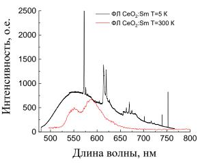
Рисунок 30 — Спектры ФЛ  $CeO_2$ :Sm, отожженного при T=400 °C, измерения при T=5 и 300 K. Энергия возбуждающих фотонов  $E_{\rm exc}=3.6$  эВ
