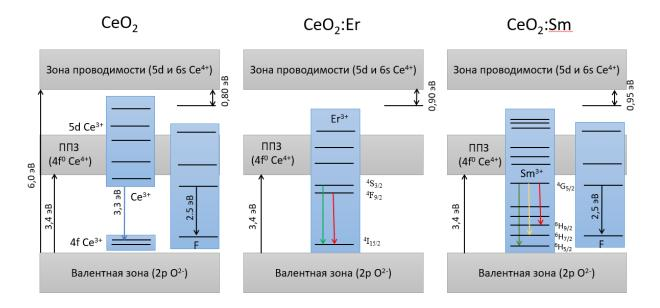
Рисунок 32 — Энергетическая зонная схема наблюдаемых электронных переходов в  $CeO_2$ ;  $Er^{3+}$  и  $CeO_2$ :  $Sm^{3+}$ .
