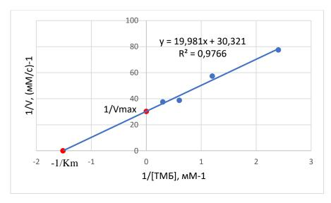
Рисунок 42 — График Лайнуивера-Берка для окисления ТМБ недопированными наночастицами CeO<sub>2</sub>
