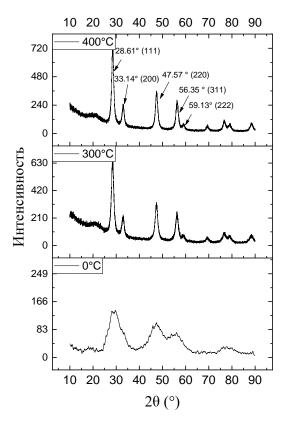
Рисунок 13 – Дифрактограмма нанопорошка СеО<sub>2</sub>
