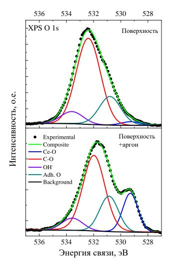
Рисунок 21 — РФЭС спектр наночастиц  $CeO_2$  в области энергий связи атомов кислорода O 1s
