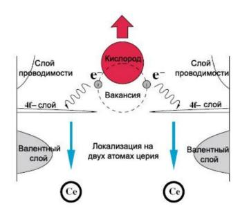
Рисунок 2 – Процесс образования кислородной вакансии в оксиде церия [17]
