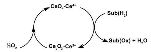
Рисунок 38 – Оксидазная активность наночастиц оксида церия
