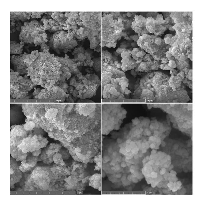
Рисунок 15 — Микрофотографии нанопорошка CeO<sub>2</sub>, синтезированного без использования мальтодекстрина (СЭМ)
