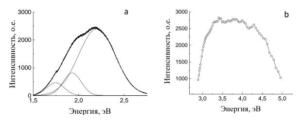
Рисунок 28 - Спектры ФЛ (а) ( $E_{exc} = 3.5 \text{ эВ}$ ) и возбуждения ФЛ (b) для  $E_{em} = 2.17 \text{ эВ}$  наночастиц  $CeO_2$  при T = 5 К (образец в таблетированной форме отожжен на воздухе при T = 500 °C)
