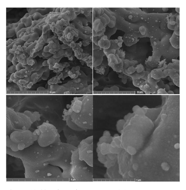
Рисунок 14 — Микрофотографии нанопорошка CeO<sub>2</sub>, синтезированного с использованием мальтодекстрина (СЭМ)
