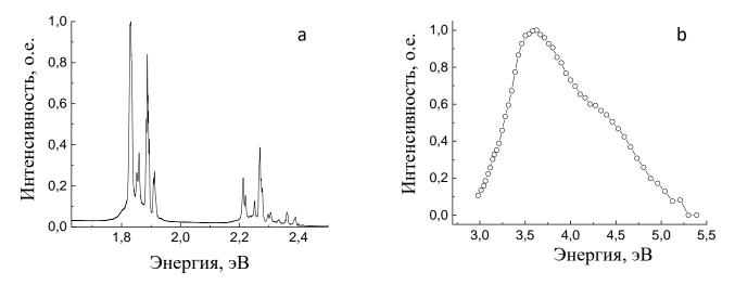
Рисунок 29 — Спектр ФЛ при возбуждении фотонами  $E_{\rm exc} = 3,58$  эВ (a) и спектр возбуждения ФЛ для линии  $E_{\rm em} = 1,85$  эВ = 669 нм (b) наночастиц  $CeO_2$ :Ег отожженных в водороде (600°С). Измерения выполнены при T=5 К
