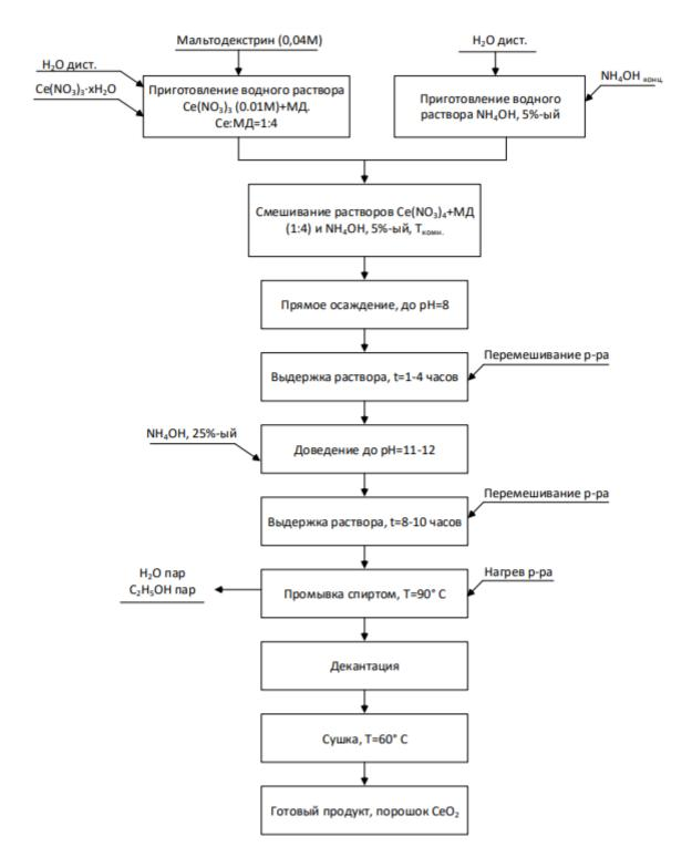
Рисунок 8 – Технологическая схема получения наночастиц СеО2
