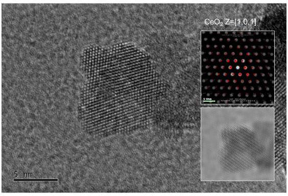
Рисунок 17 — Микрофотографии нанопорошка CeO<sub>2</sub>, синтезированного без использования мальтодекстрина (ПЭМ-ВР)
