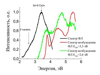
Рисунок 27 - Спектр ФЛ (при возбуждении  $E_{\rm exc} = 5.0~{\rm pm}$ ) и спектры возбуждения ФЛ водной суспензии наночастиц  ${\rm CeO_2}$  для полос эмиссии  $E_{\rm em} = 3.3~{\rm m}~2.6~{\rm pm}$ ,  $T = 295~{\rm K}$
