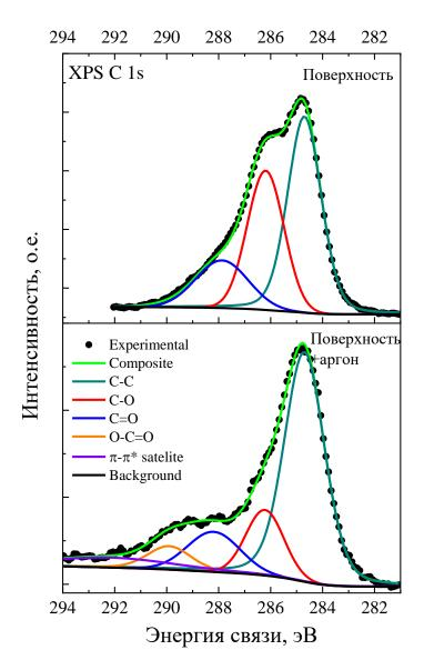
Рисунок 20 — РФЭС спектр наночастиц  $CeO_2$  в области энергий связи атомов углерода C 1s
