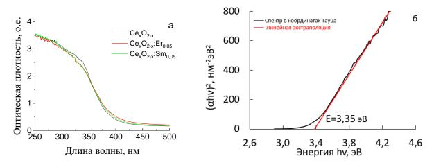
Рисунок 24 — Спектры оптического поглощения водной суспензии наночастиц CeO<sub>2</sub> (a) и определение энергии полосы переноса заряда методом Тауца (b)
