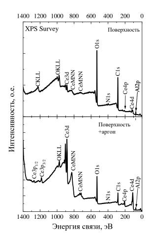
Рисунок 18 – Спектры РФЭС CeO<sub>2</sub>, синтезированного с использованием мальтодекстрина: верхний рисунок – необработанная поверхность образца, нижний – после травления ионами аргона
