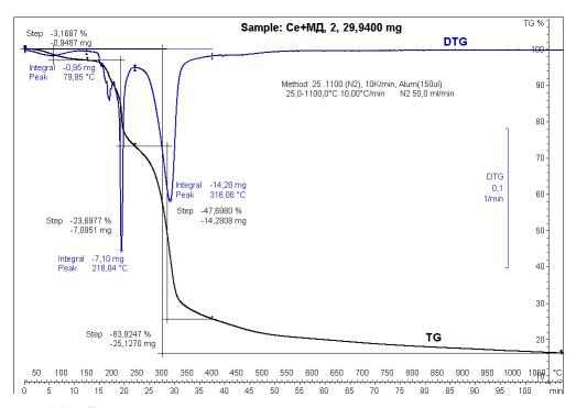
Рисунок 12 — Результаты термогравиметрического анализа нанопорошка CeO<sub>2</sub>
