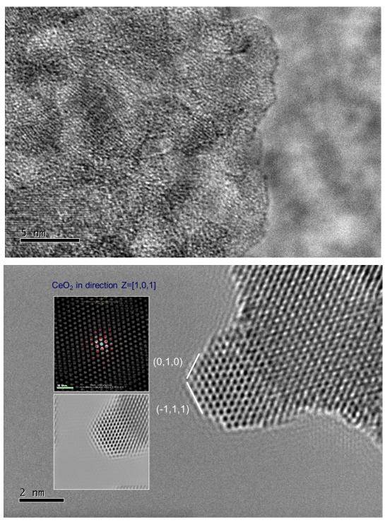
Рисунок 16 – Микрофотографии нанопорошка CeO<sub>2</sub>, синтезированного с использованием мальтодекстрина (ПЭМ-ВР)
