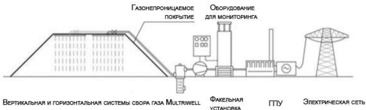
Рисунок 2.3 – Схематическое изображение системы извлечения свалочного газа Multiwell
