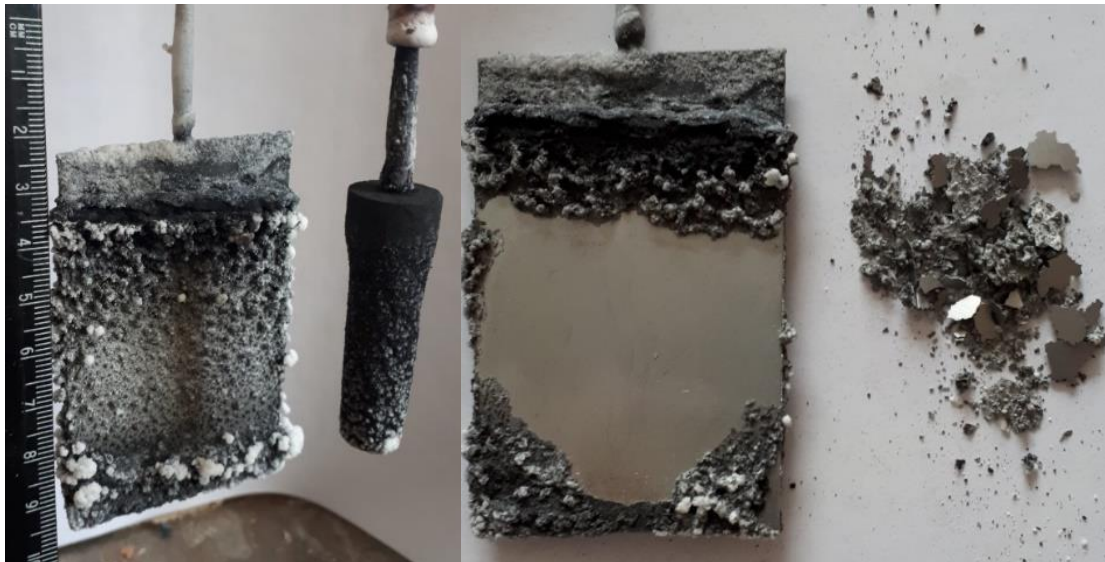
Рисунок 9 – Фотографии электродов и катодного осадка после электролиза
