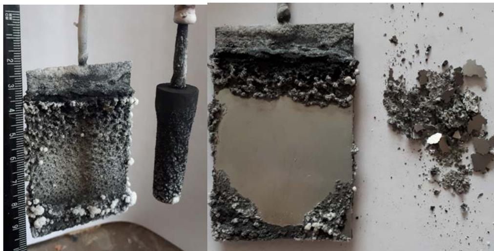
Рисунок 2.11 – Внешний вид электродов и катодного осадка после электролиза
