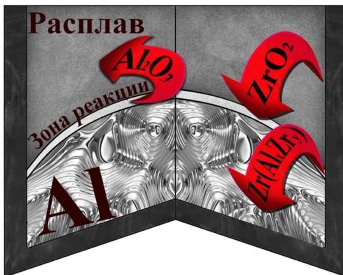
Рисунок 3.1 – Схема алюмотермического восстановления  $ZrO_2$
