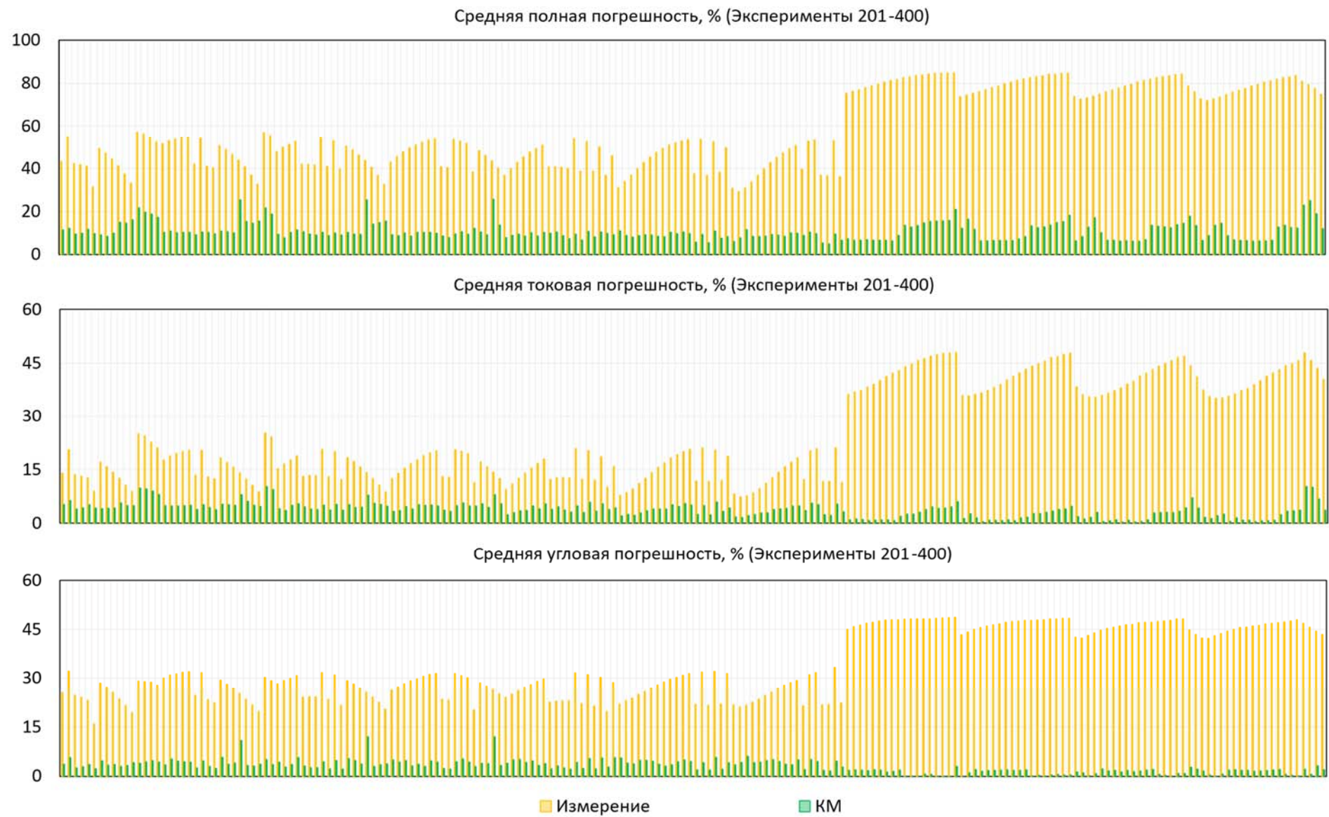
Рисунок Б 8 Результат работы метода КМ при вариации аperiodической составляющей тока КЗ, эксперименты 201-400
