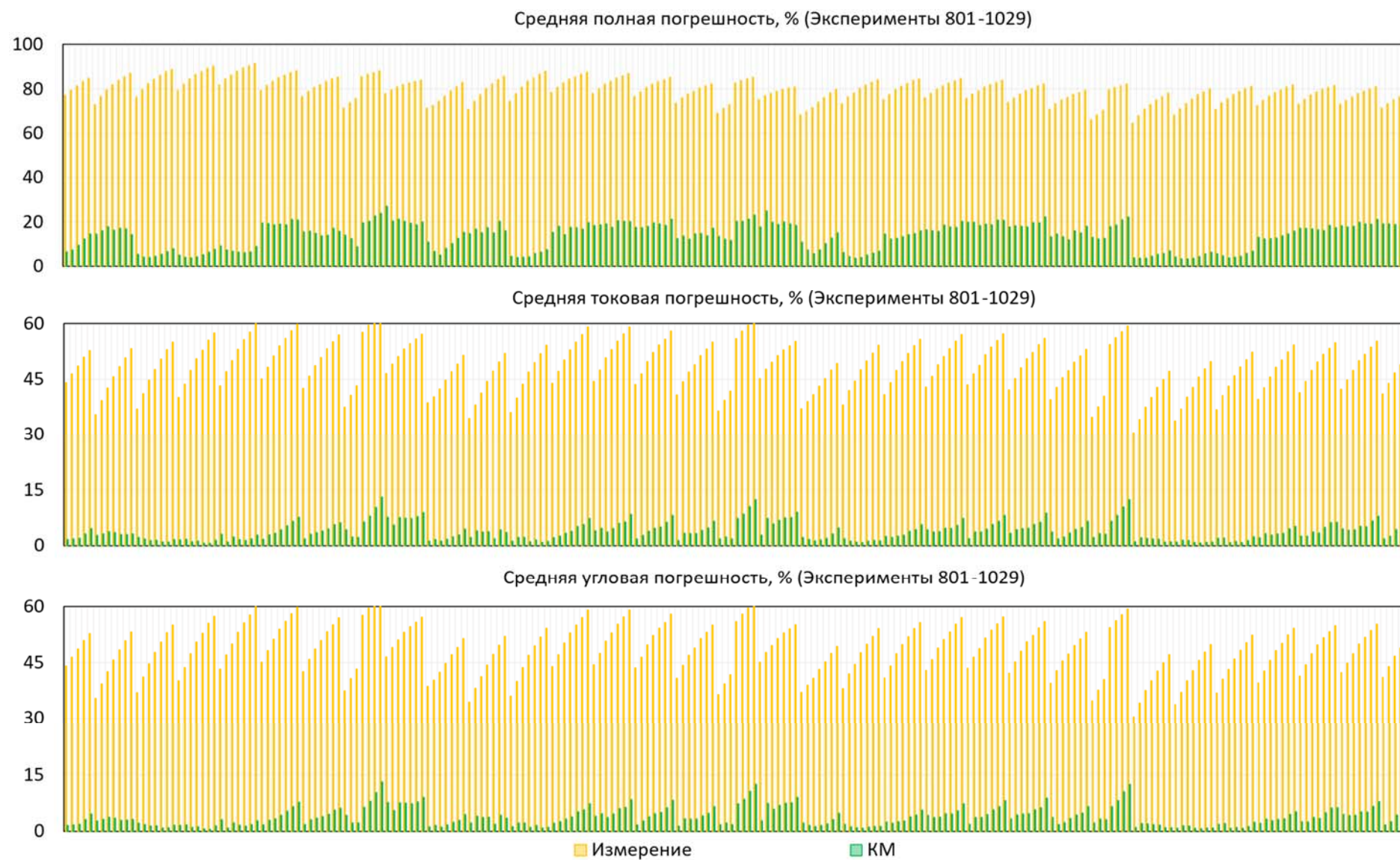
Рисунок Б 6 Результат работы метода КМ при вариации нагрузки ТТ, эксперименты 801-1029
