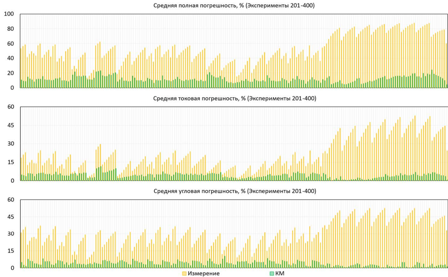
Рисунок Б 3 Результат работы метода КМ при вариации нагрузки ТТ, эксперименты 201-400
