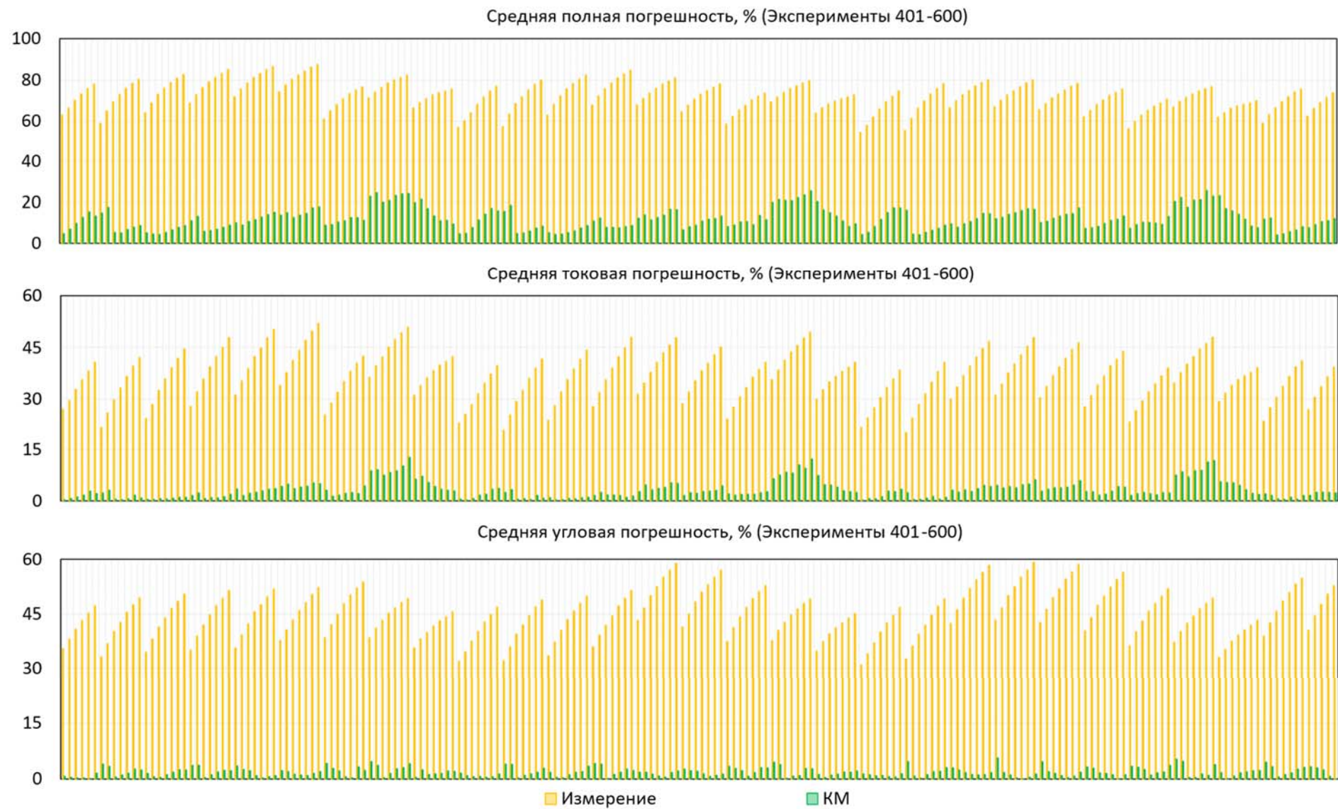
Рисунок Б 4 Результат работы метода КМ при вариации нагрузки ТТ, эксперименты 401-600
