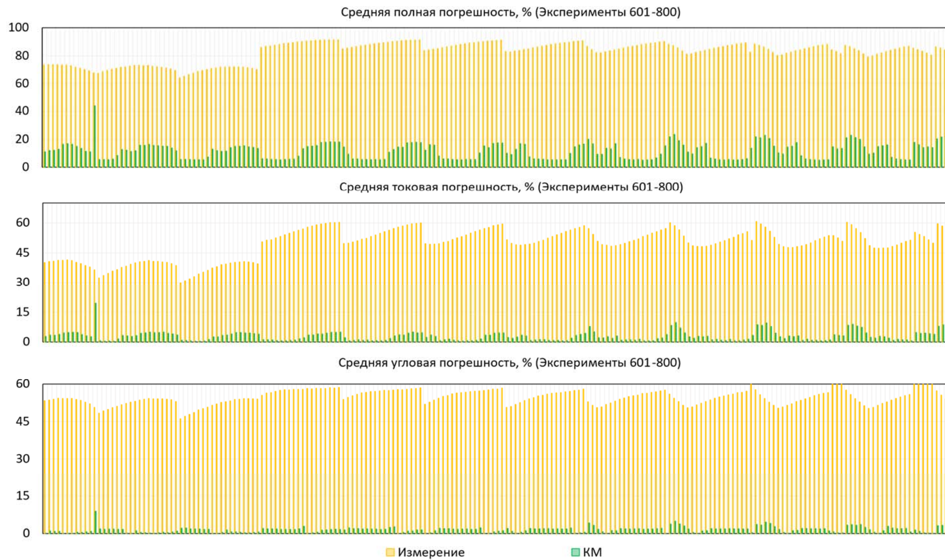
Рисунок Б 10 Результат работы метода КМ при вариации аperiodической составляющей тока КЗ, эксперименты 601-800
