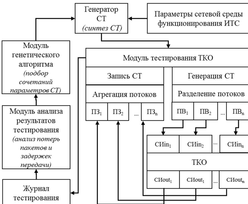
Рисунок 3.9. Структура экспериментального стенда для оценки защищенности ТКО от сетевых компьютерных атак типа «отказ в обслуживании»
