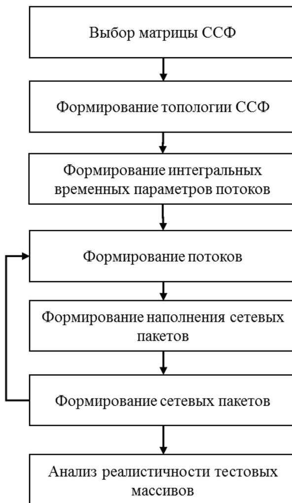
Рисунок 2.10. Схема алгоритма синтеза фонового сетевого трафика
