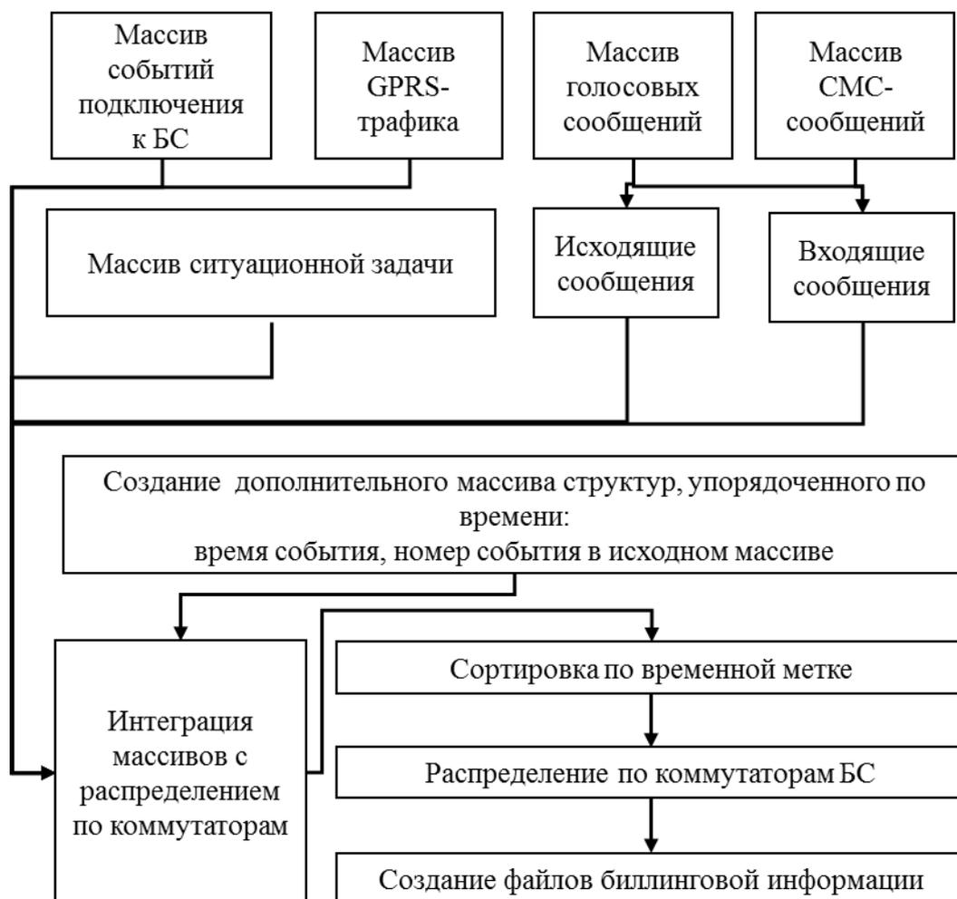
Рисунок 2.25. Схема синтеза массивов данных биллинговой, распределенных по коммутаторам операторов сетей сотовой связи
