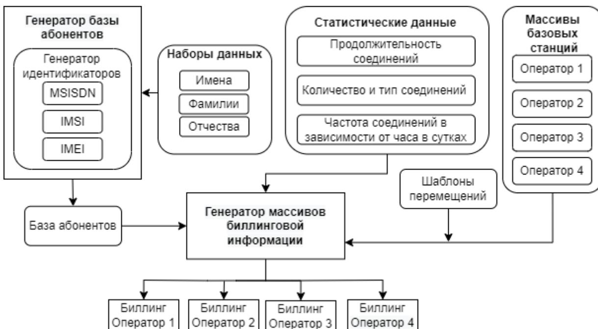
Рисунок 4.10. Схема синтеза массивов биллинговой информации
