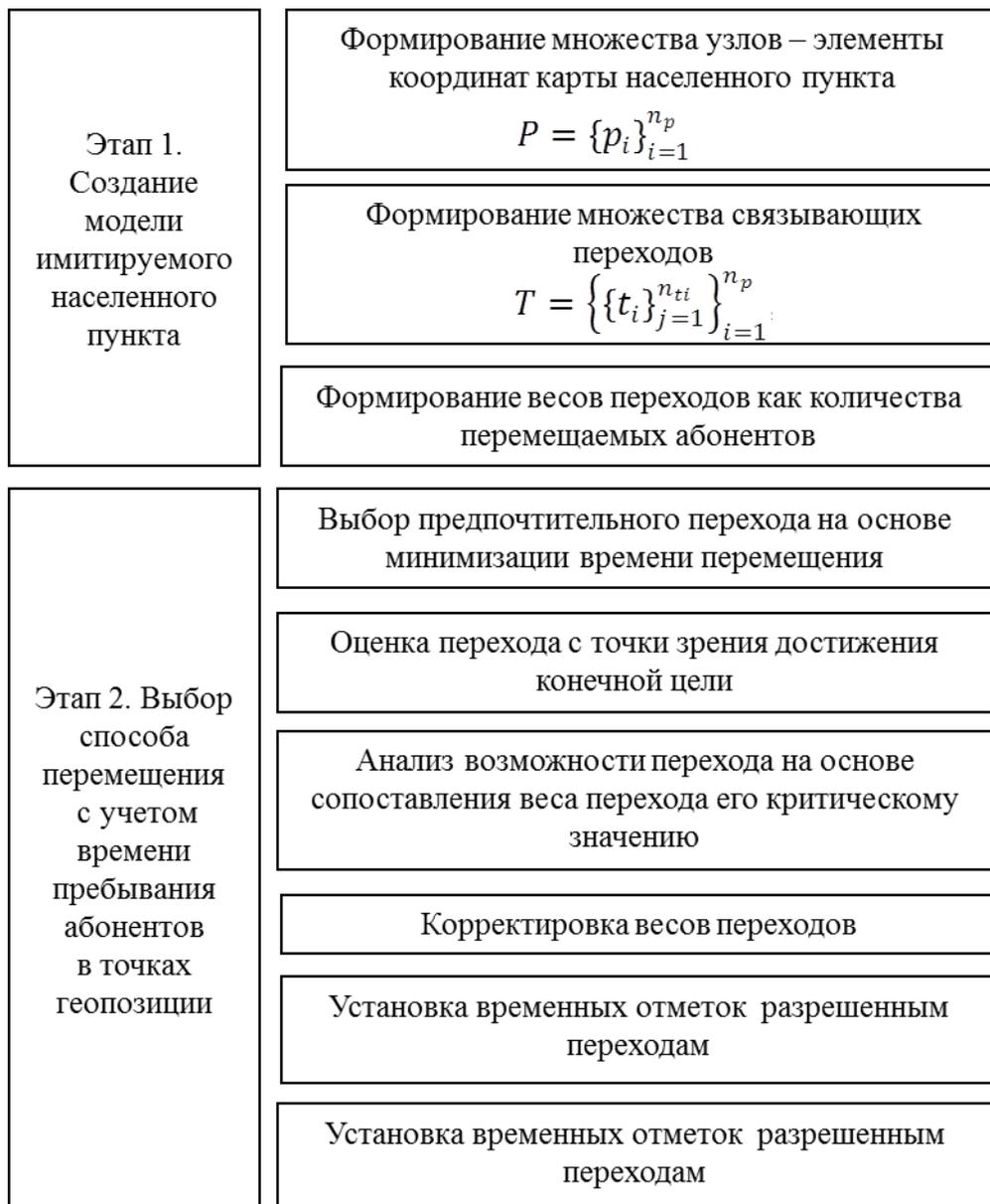
Рисунок 2.26. Схема создания динамической модели перемещения абонентов в терминах сетей Петри
