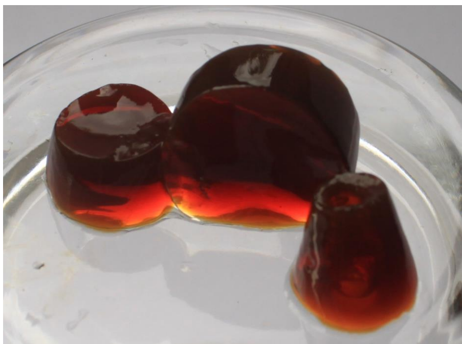
Рисунок 3.6 Внешний вид феррогелей полиакриламида, содержащих наночастицы оксида железа
