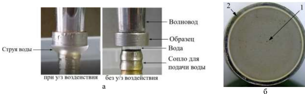
Рисунок 2 – Вид образцов: (а) – зона испытания; (б) – рабочая поверхность после кавитационных испытаний при у/з воздействия, 1 – зона кавитации, 2 – неповрежденная зона
