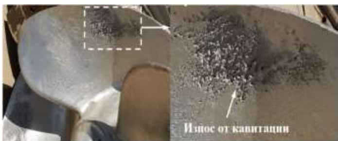
Рисунок 12 – Кавитационное разрушение на поверхности крыльчатки водяного насоса на электростанции Дора в Багдаде, Ирак
