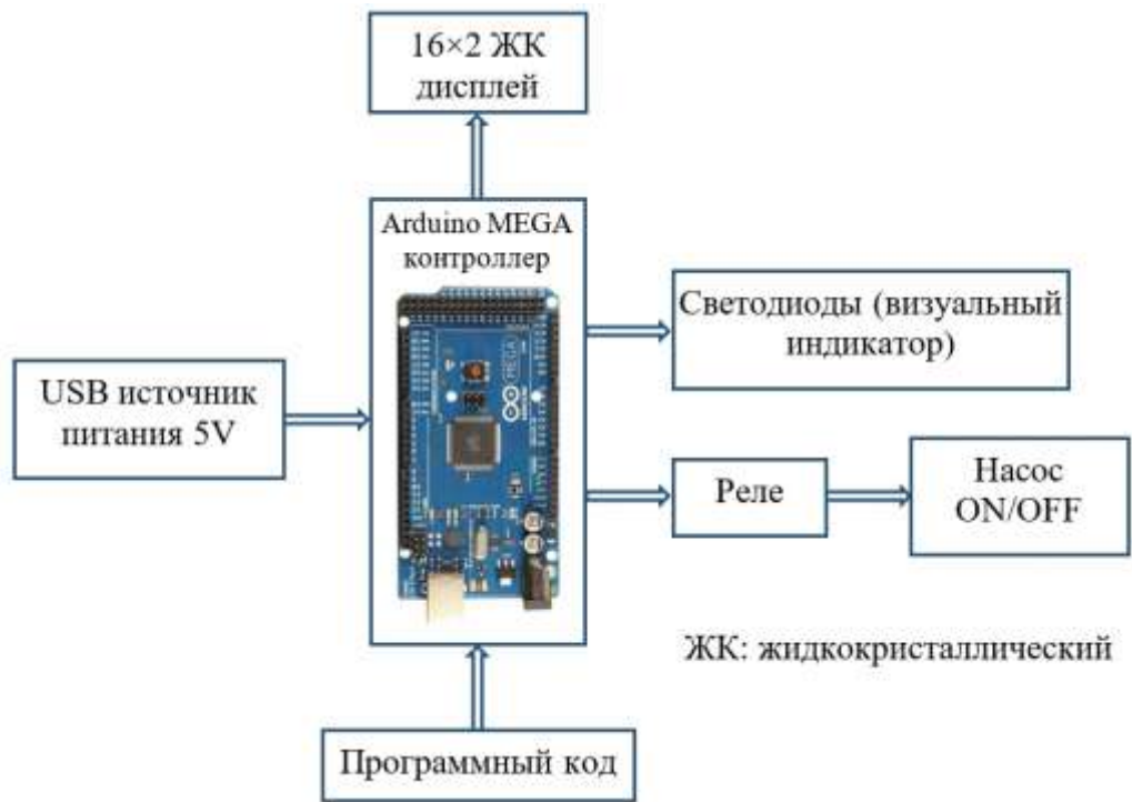
Рисунок 3.4 – Функциональная схема контроллера водяного насоса «Решение на основе времени»
