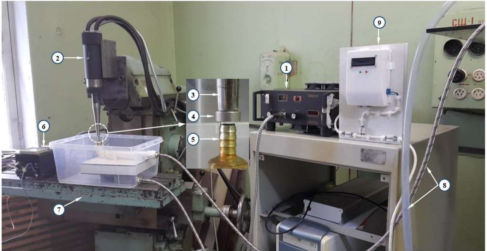
Рисунок 3.2 – Общий вид установки для испытаний на кавитационную стойкость: 1–ультразвуковой генератор; 2–ультразвуковой преобразователь; 3– акустический преобразователь; 4–испытуемый образец; 5–сопло; 6–конвертер; 7–подвижный стол; 8–шланги; 9–контроллер
