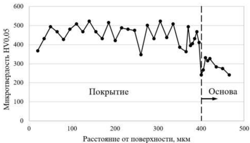
Рисунок 4.20 – Изменения микротвердости по глубине NiCrMoNb покрытия
