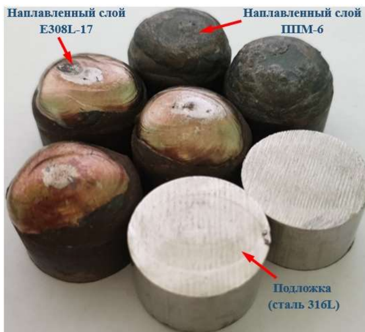
Рисунок 2.4 – Способ подготовки наплавленных слоев на основной металл методами TIG и РДС
