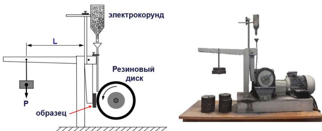
Рисунок 2.6 – Установка Бринелля-Ховарта для исследования износостойкости
