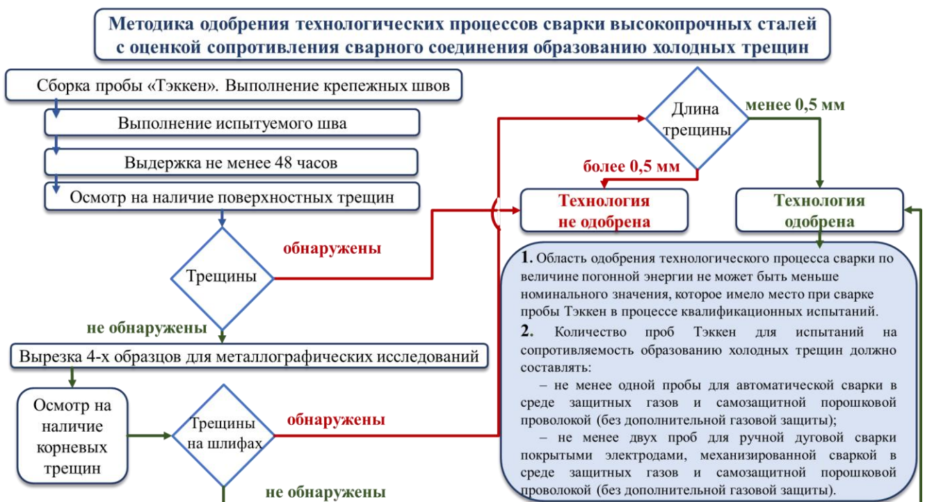
Рисунок 12 – Схема проведения одобрения технологии сварки высокопрочных сталей
