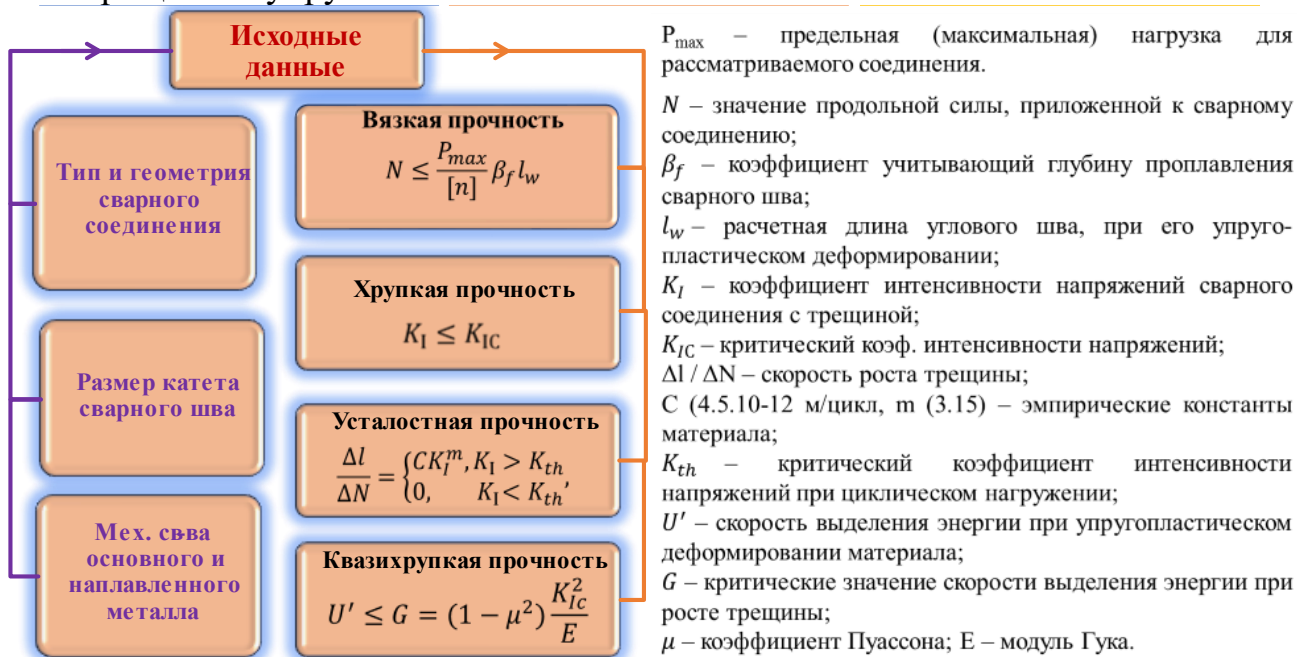
Рисунок 6 – Алгоритм расчетной оценки конструкционной прочности сварного соединения
