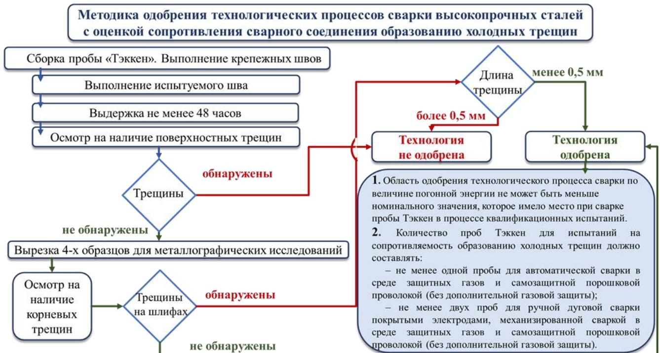
Рисунок 4.14 – Схема проведения одобрения технологии сварки высокопрочных сталей
