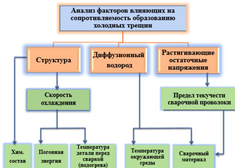
Рисунок 1.2 – Анализ факторов, влияющих на появление холодных трещин
