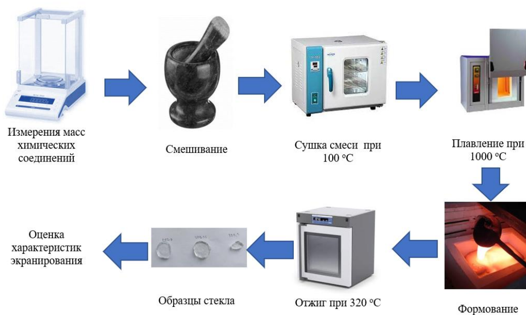
Рисунок 5. Основные этапы подготовки и оценки радиационно-защитных свойств изготовленного боратного стекла
