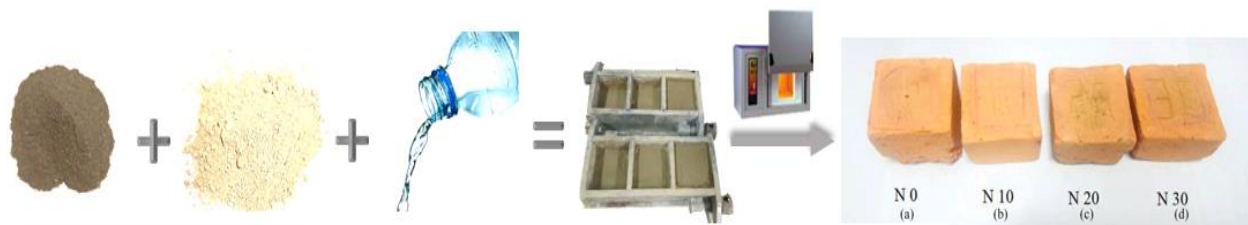
Рисунок 2.7. Этапы процесса изготовления кирпича
