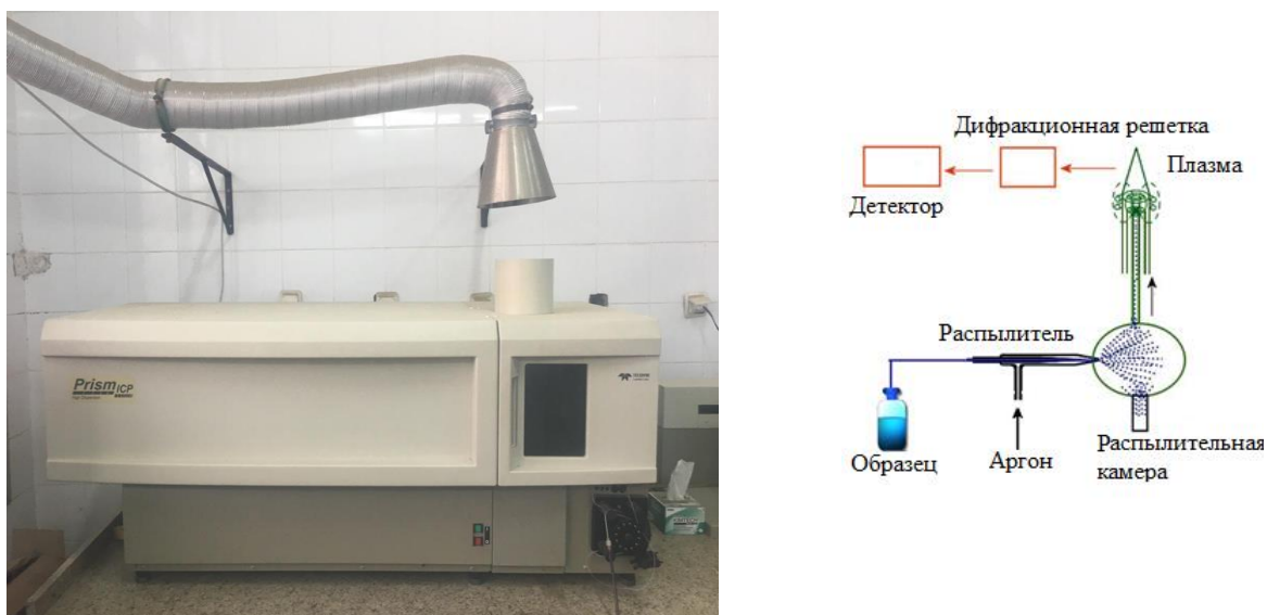
Рисунок 2.3. Схема определения химического состава с помощью метода оптико-эмиссионного спектрометра с индуктивно связанной плазмой
