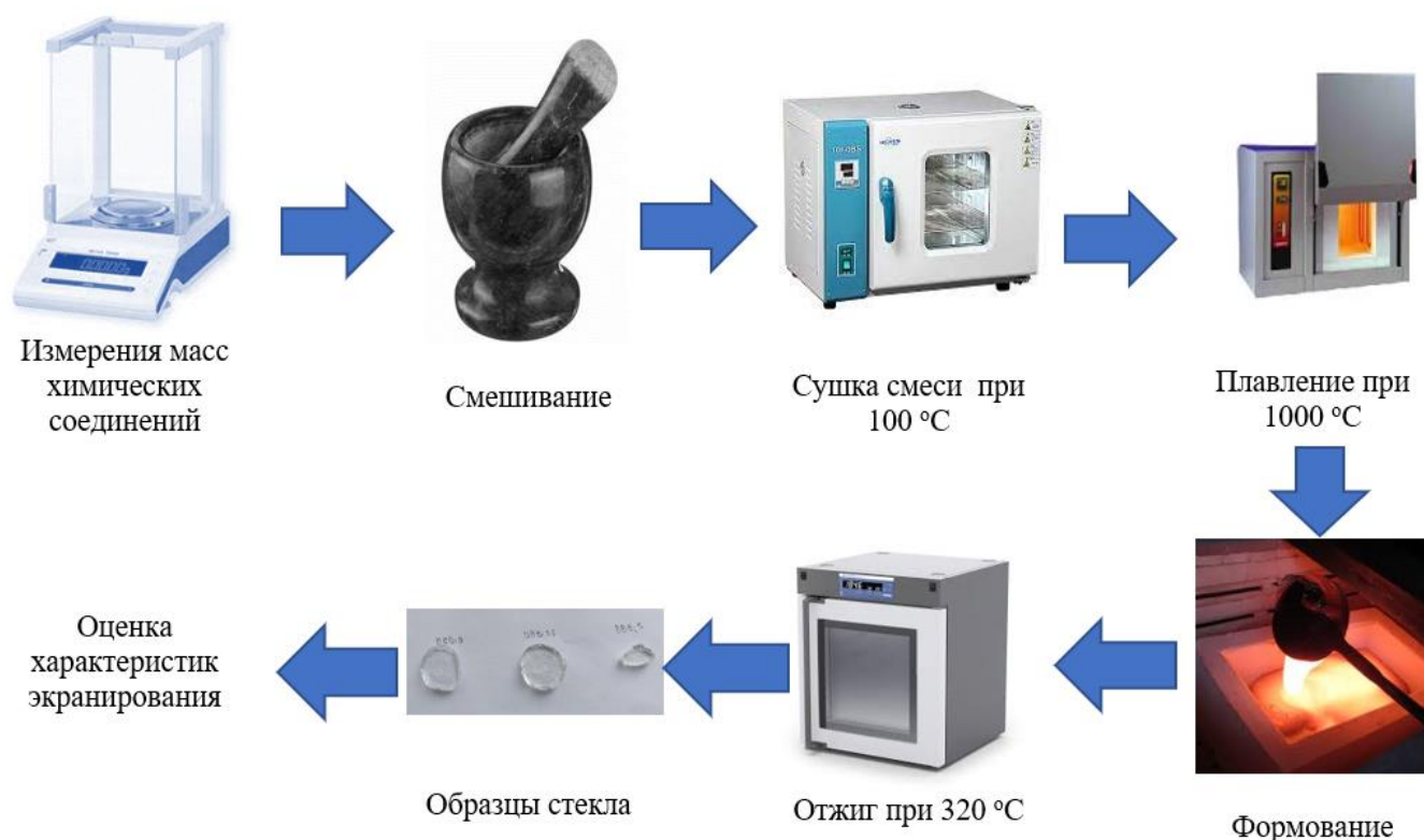
Рисунок 2.8. Основные этапы подготовки и оценки радиационно-защитных свойств изготовленного боратного стекла
