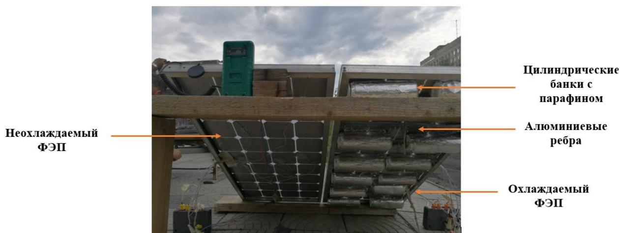
**Рис. 19.** Экспериментальная установка с размещением парафина на задней стороне панели ФЭП
