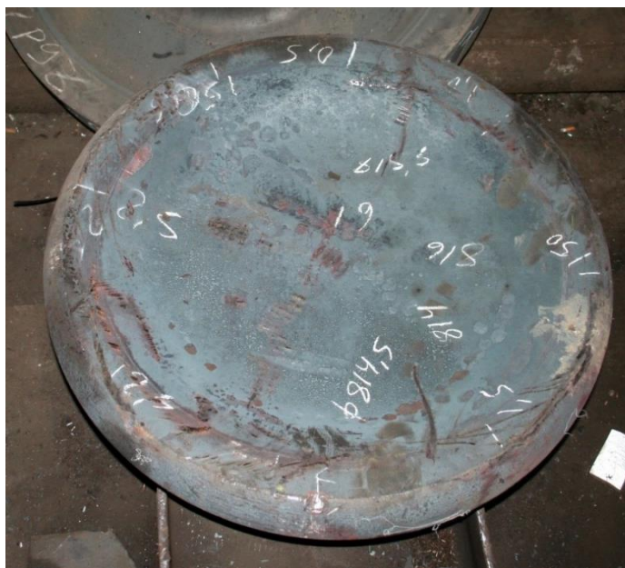
Рисунок 3.3 – Фото поковки после операции предварительной штамповки (внутренняя сторона)
