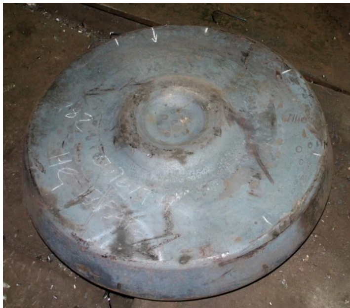
Рисунок 3.2 – Фото поковки после операции предварительной штамповки (наружная сторона)
