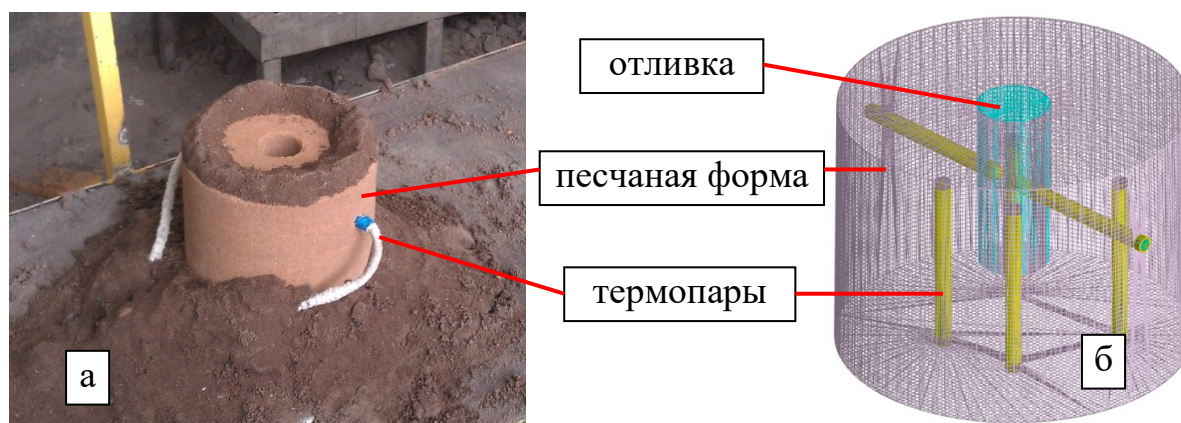
Рисунок 2 – Натурный эксперимент (а) и компьютерная модель (б) цилиндрической тестовой отливки в песчаной форме с 6 термопарами
