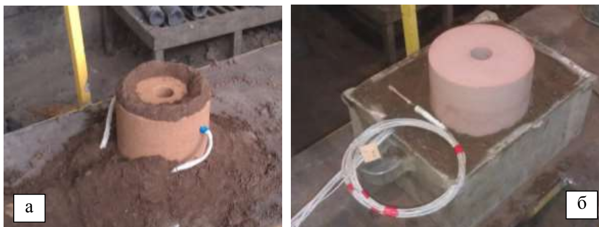
Рисунок 3.7 – Подготовка эксперимента по затвердеванию тестовой отливки в цилиндрической форме в заводских условиях
