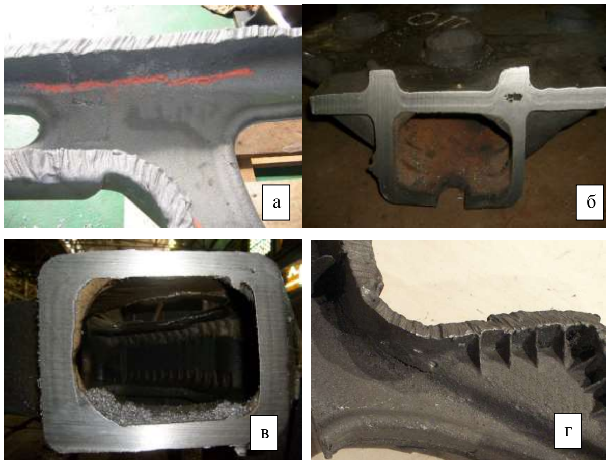
Рисунок 5.28 – Усадочные дефекты на внутренней поверхности (а) и в теле отливки «Рама боковая» (б, в); горячие трещины (г)
