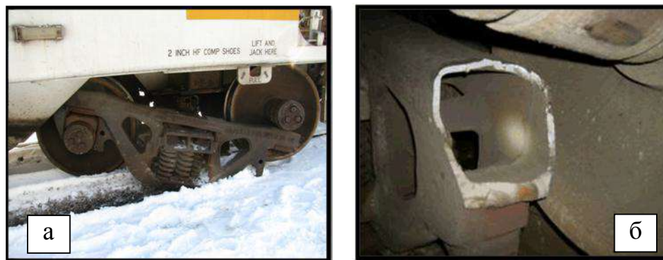
Рисунок 1.1 – Аварийная ситуация на железной дороге в США (а) как результат разрушения литой боковой рамы (б)
