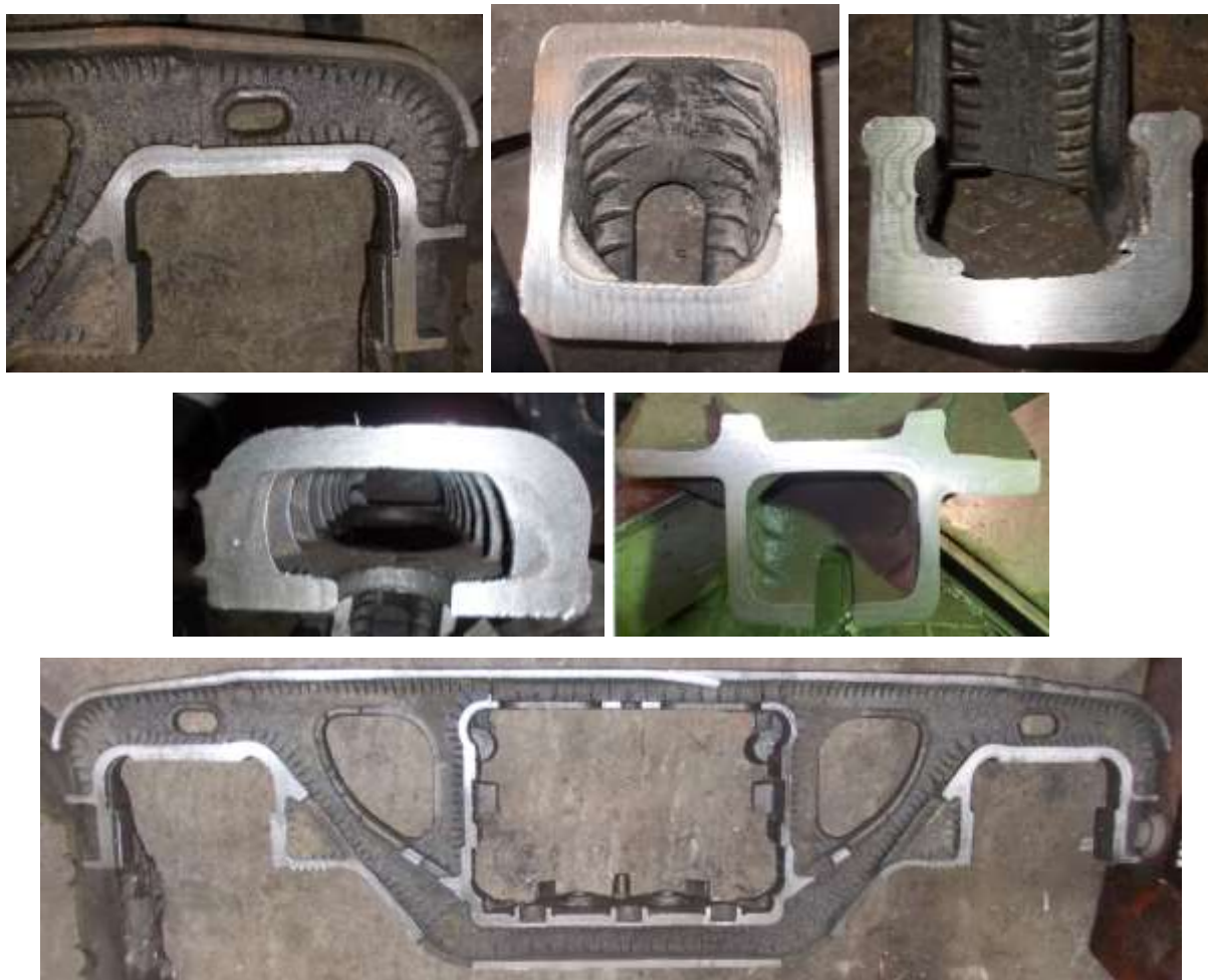
Рисунок 5.42 – Отсутствие дефектов в сечениях отливки «Рама боковая», подтвержденное порезкой механическим способом в соответствии с требованиями предусмотренных периодических испытаний
