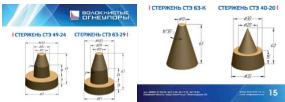
Рисунок 5.8 – Осесимметричная геометрия экзотермических стержней-вставок производства компании «Волокнистые огнеупоры»
