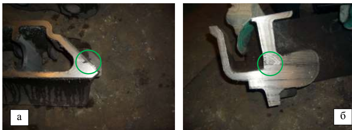
Рисунок 3.5 – Фактические дефекты в сечениях отливки «Балка надрессорная»
