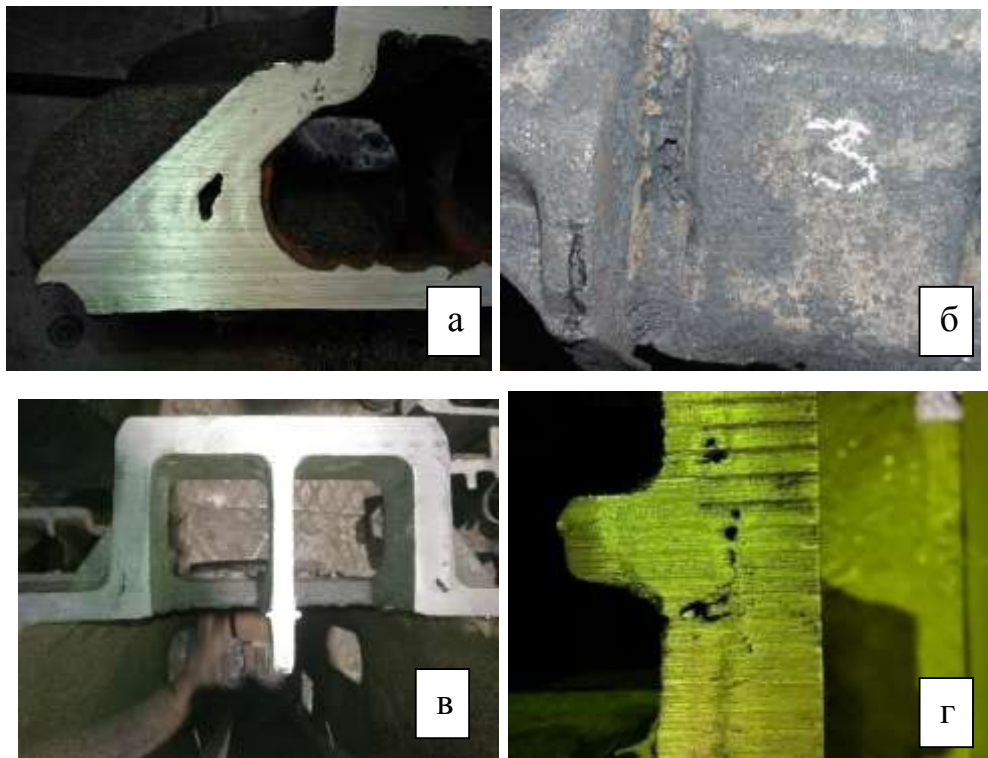
Рисунок 5.44 – Усадочные дефекты, обнаруженные в отливке «Балка надрессорная» при порезке: зона 1 (а, б); зона 3 (в, г)
