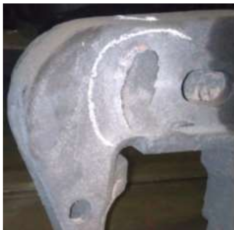
Рисунок 5.5 – Дефект ужимина на отливке «Рама боковая»
