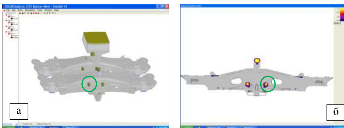
Рисунок 3.4 – Результаты компьютерного моделирования отливки «Балка надрессорная» в программе SolidCast: локализация усадочных дефектов (а) и тепловые узлы (б)
