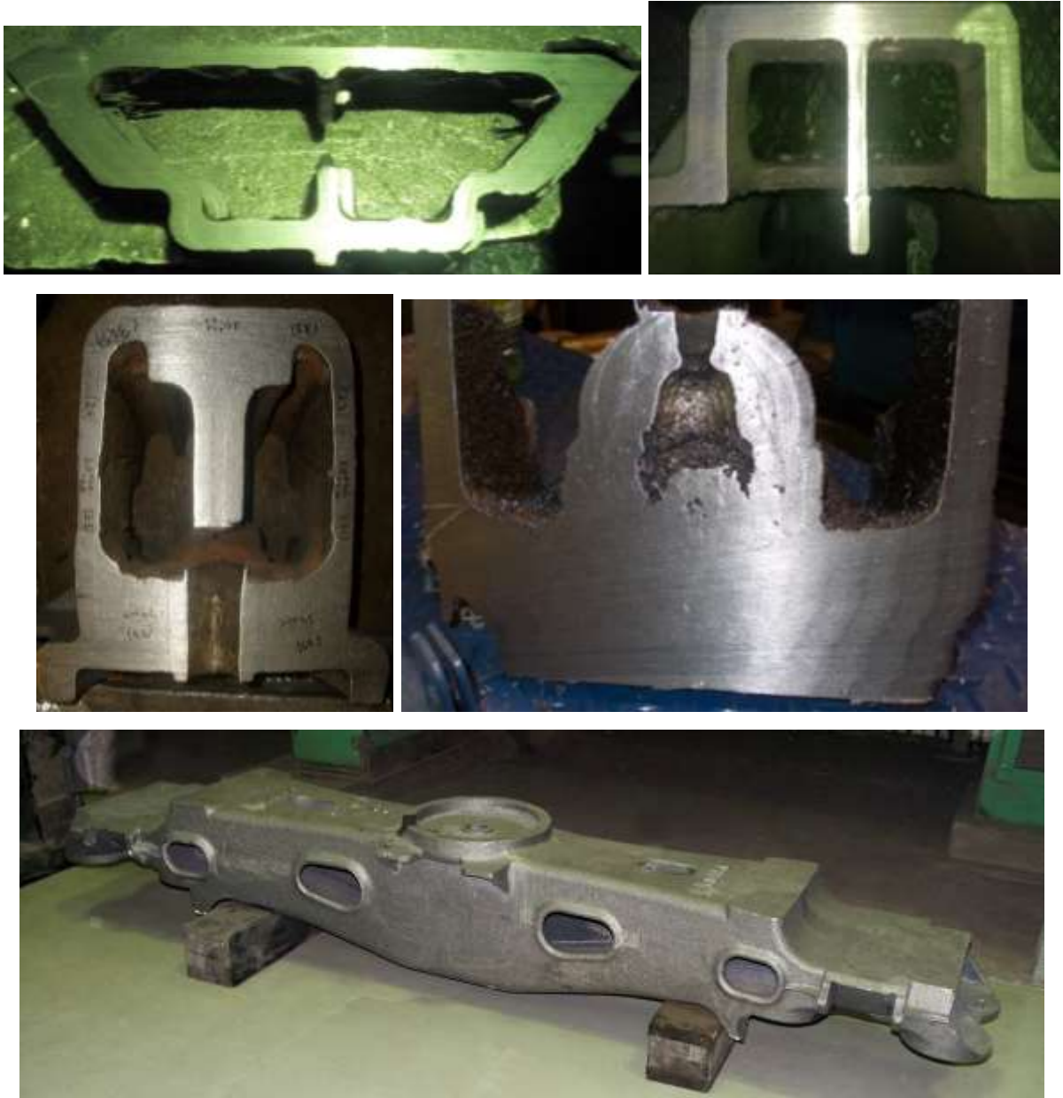
Рисунок 5.52 – Отсутствие дефектов в сечениях отливки «Балка надрессорная», подтвержденное порезкой механическим способом в соответствии с требованиями предусмотренных периодических испытаний
