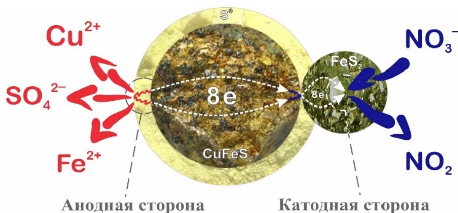
Рисунок 11 – Схема электрохимического азотнокислотного выщелачивания халькопирита и пирита в гальванической связи
