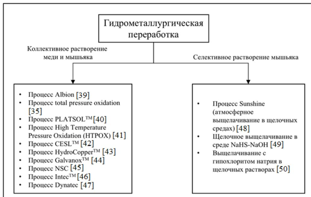
Рисунок 1.1 - Схема процессов, применимых для переработки медно-мышьяковистых концентратов
