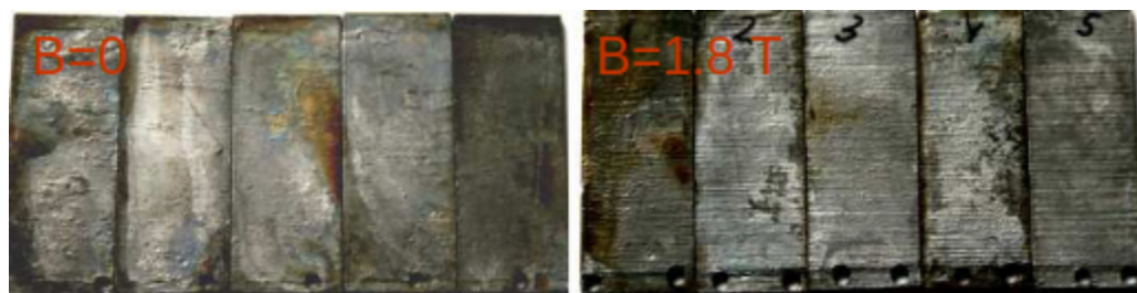
Рис. 1.1 — Сравнение коррозии металла пяти заготовок, изготовленных при воздействии магнитным полем и без этого воздействия [74].
