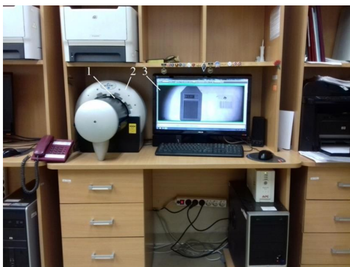
Рисунок 4.11. Комплект сканера КЦР «Градиент»: 1 – входная щель; 2 – модуль удаления данных; 3 - монитор
