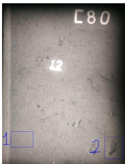
Рисунок 4.3. Радиограмма С-80-5 с дефектами
