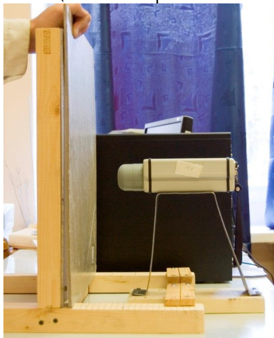
Рисунок 4.25. Измерение мощности дозы от источника \gamma -излучения закрытого защитным материалом
