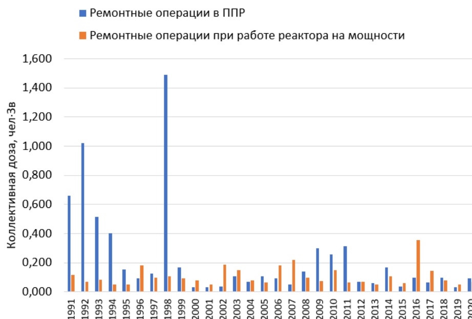
Рисунок 1.13. Коллективные дозозатраты по видам ремонтных работ при РОР на РУ БН-600, чел·Зв
