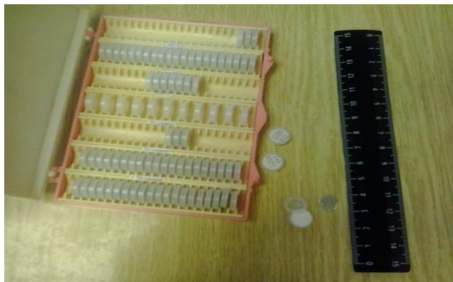
Рисунок 4.19. Нейтронно-активационные детекторы, облучаемые в реакторе ИВВ-2М: кобальт металлический ( ^{59}\text{Co} ); никель металлический ( ^{58}\text{Ni} ); золото, сплав с алюминием ( ^{197}\text{Au} ); железо металлическое ( ^{54}\text{Fe} ); алюминий металлический ( ^{27}\text{Al} )
