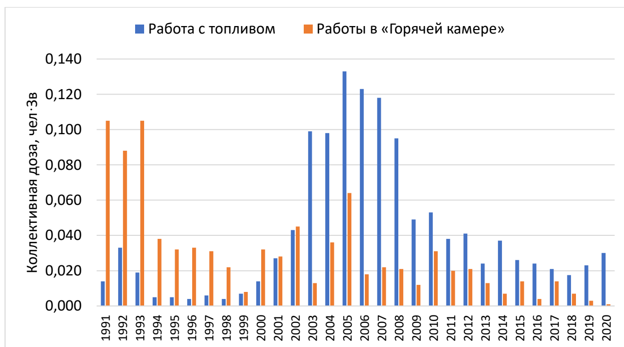
Рисунок 1.15. Коллективные дозозатраты по видам работ (работы с топливом и в горячей камере при РОР на РУ БН-600, чел·Зв)
