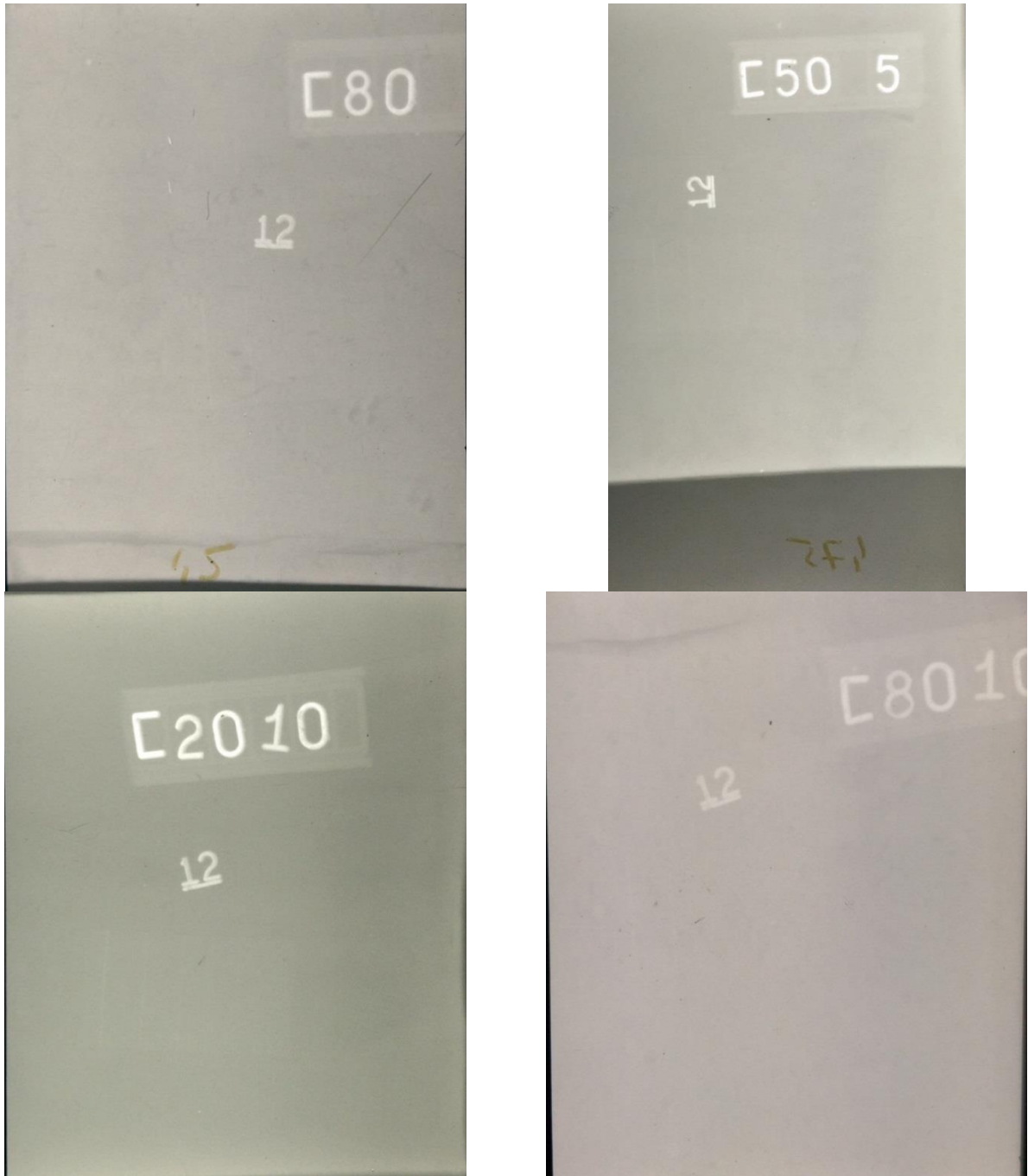
Рисунок 4.6. Радиограммы РЗМ со свинцовым наполнителем, полученные с использованием гамма-излучения
