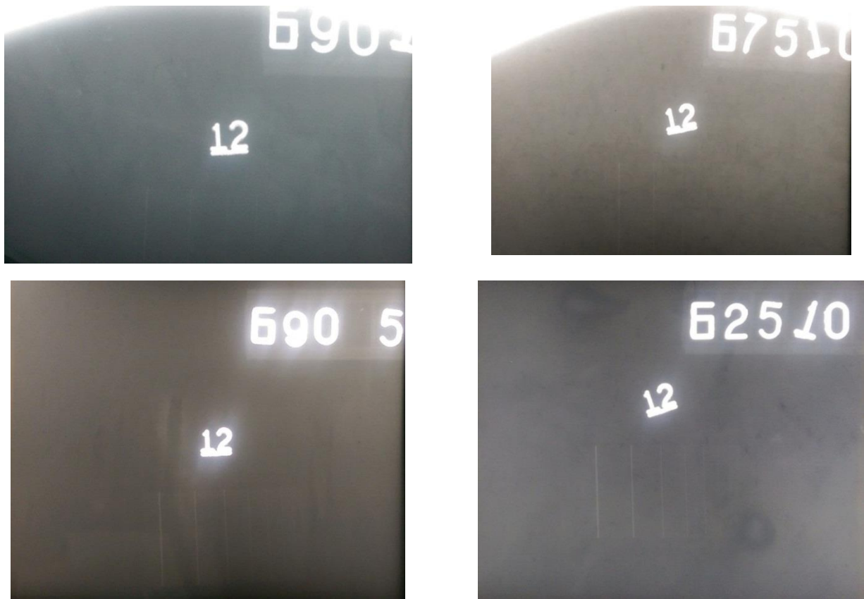
Рисунок 4.9. Радиограммы РЗМ с баритовым наполнителем, полученные с использованием рентгеновского излучения
