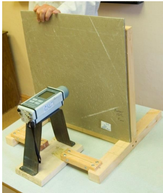
Рисунок 4.24. Измерение мощности дозы от источника \gamma -излучения закрытого защитным материалом
