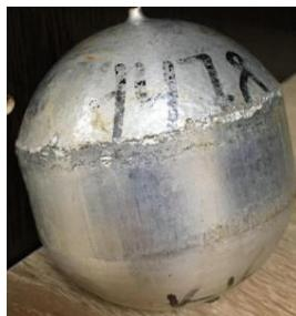
Рисунок 7 – Схема испытания шара на выдавливание гидростатическим давлением (а) и фото магниевого шара, прошедшего испытание (б)
