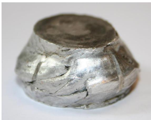
Рисунок 2.5 – Фото магниевой заготовки после осадки в медной оболочке при соотношениях  $h_0/H_0 = 1$ ,  $s_0/D_0 = 0,13$
