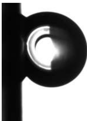
Рисунок 2.40 - Фотография капли воды на поверхности полимера p[1Naph-PheDOT] p(4) , электрохимически приготовленного в 0.1 \text{ M Bu}_4\text{NClO}_4/\text{CH}_2\text{Cl}_2 методом циклической вольтамперометрии ( E = -1 / +1,70 \text{ В} ; 5 сканирований) и наклоненного под углом 90^\circ
