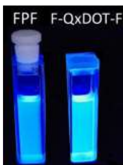
Рисунок 2.48 - Фотографии растворов тримеров F-P-F (12) и F-QxDOT-F (13) в растворе дихлорметана при УФ-облучении с \lambda=360 нм
