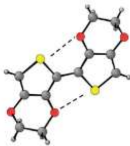
Рисунок 1.6 – Структура соединения EDOT по данным РСА
