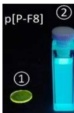
Рисунок 2.54 - Фотографии плёнки p[P-F8] (14) (1) и раствора p[P-F8] (14) (2) в дихлорметане при УФ-облучении с \lambda=360 нм
