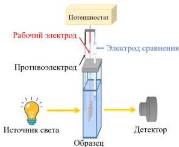
Рисунок 2.50 - Принципиальная схема спектроэлектрохимического оборудования
