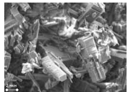
Рисунок 2.6 – СЭМ изображения изучаемых образцов фосфогипсов
