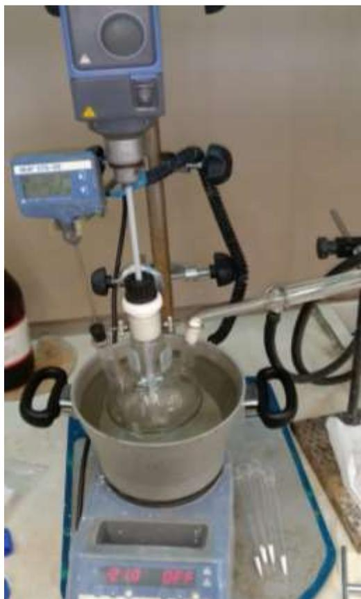
Рисунок 3.1 – Внешний вид лабораторной установки для изучения кинетики выщелачивания РЗЭ из фосфогипса
