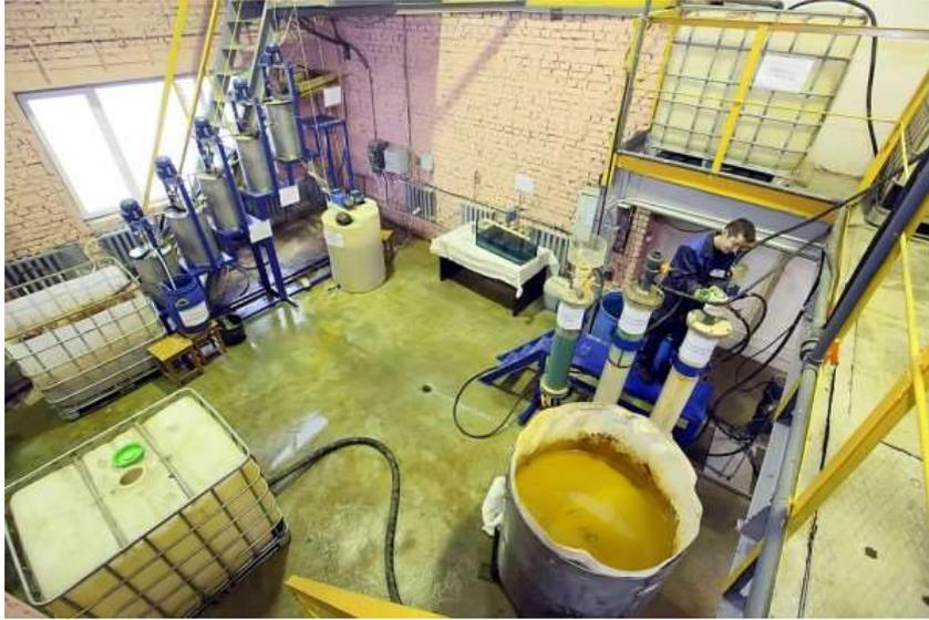
Рисунок 5.5 – Экспериментальная установка для отработки технологии извлечения РЗЭ из фосфогипса методом сорбционного выщелачивания
