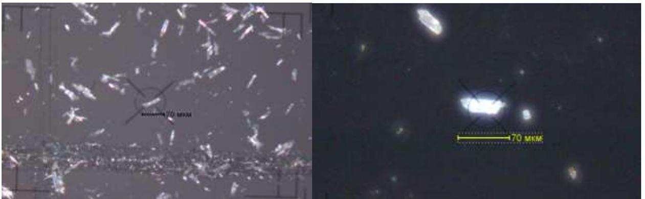
Рисунок 2.2 – Схема определения отдельных кристаллов изучаемых образцов сульфата кальция для исследований методом ВИМС
