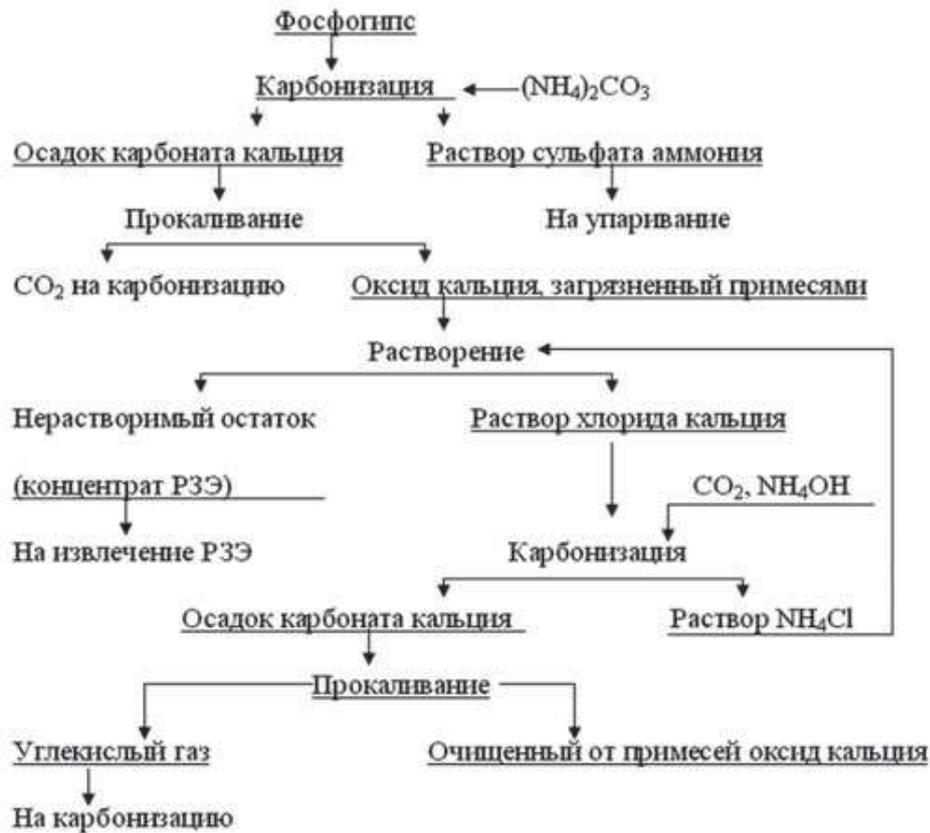
Рисунок 1.1 – Принципиальная технологическая схема комплексной переработки фосфогипса конверсионным способом
