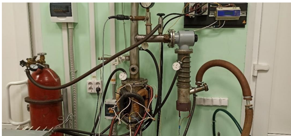
Рисунок 2. Экспериментальная установка для измерения электрического сопротивления
