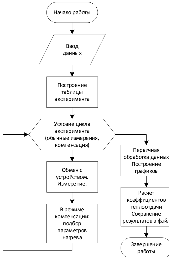
Рисунок 4. Блок схема алгоритма работы программы управления экспериментом
