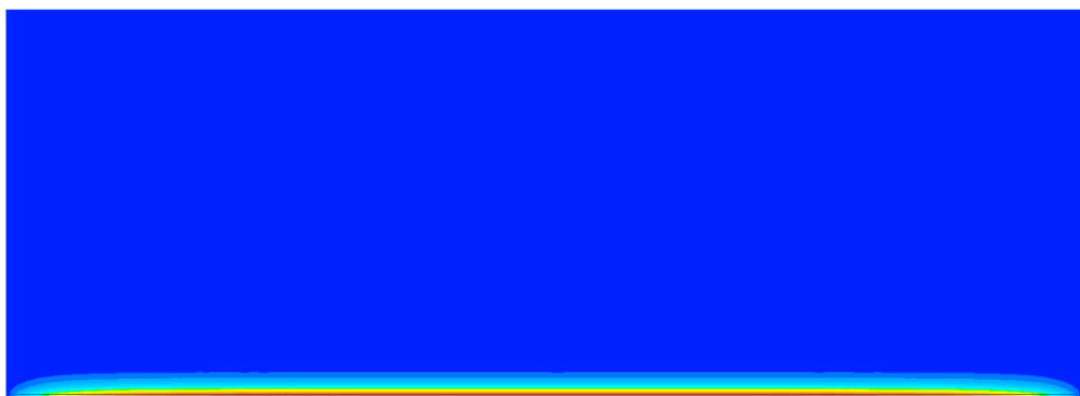
Рисунок 2.14. Расчетное распределение значений температуры в °С вдоль проволоки длиной 3 мм и диаметром 20 мкм в конце второго импульса нагрева.
