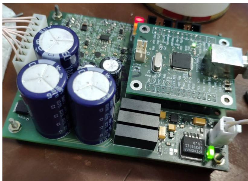
Рисунок 3.2. Внешний вид монтажа устройства управления нагревом проволочного зонда.
