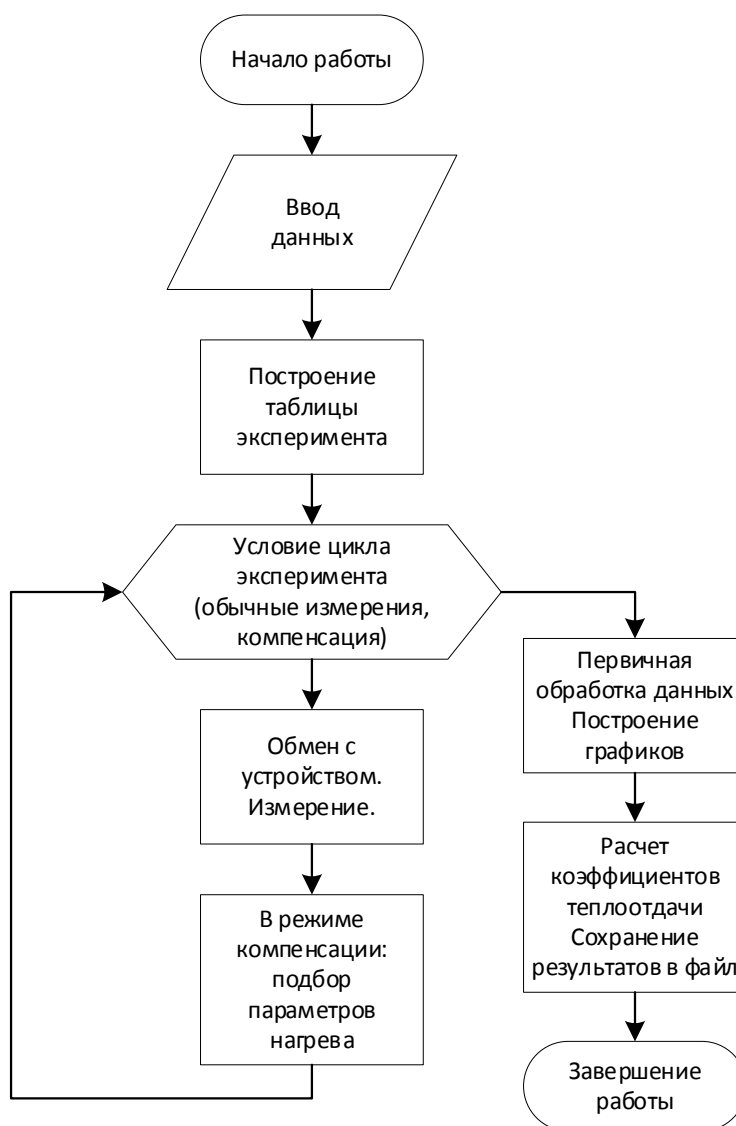
Рисунок 3.11. Блок-схема алгоритма работы программы.
