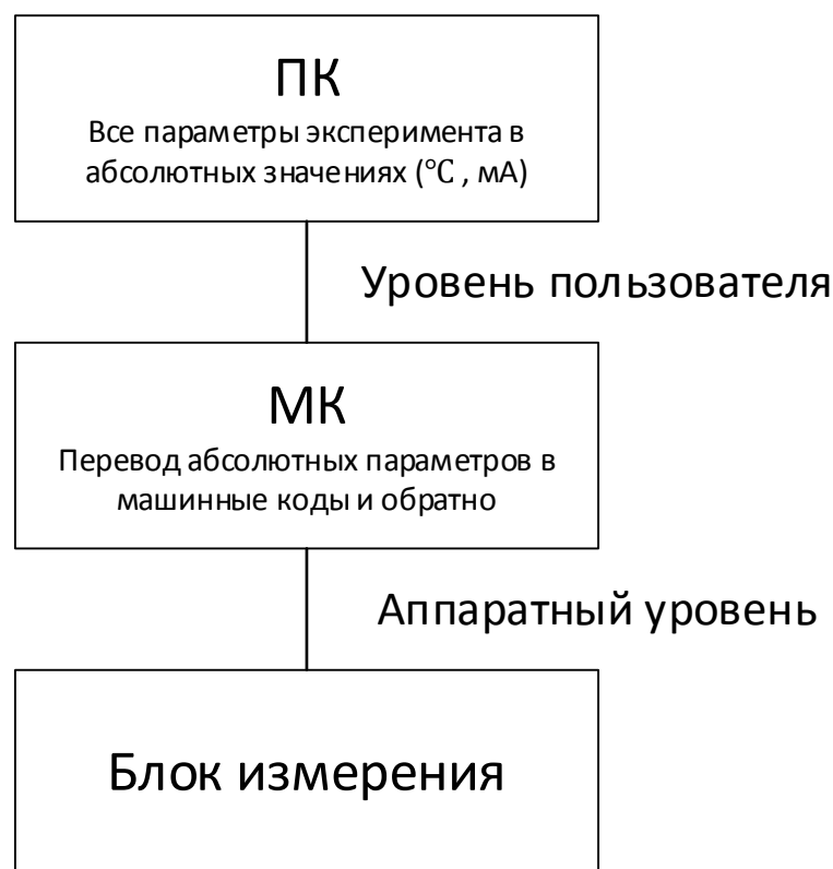
Рисунок 3.7. Блок-схема уровней программного обеспечения устройства.
