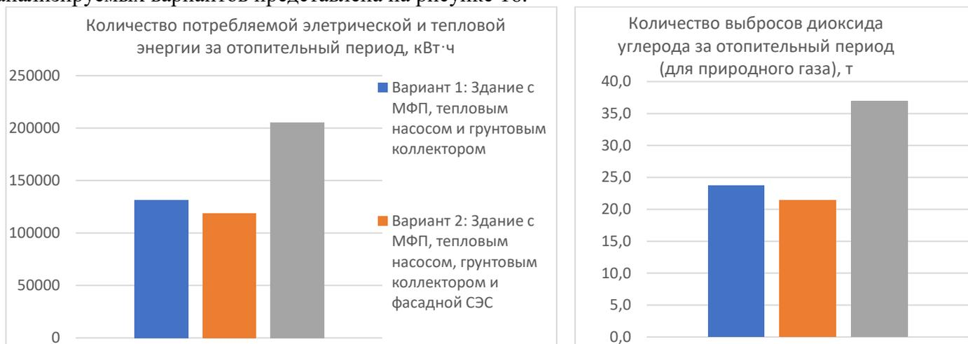
Рис. 16. Диаграмма потребляемой энергии и количества выбросов парниковых газов за отопительный период для трех вариантов исполнения зданий
