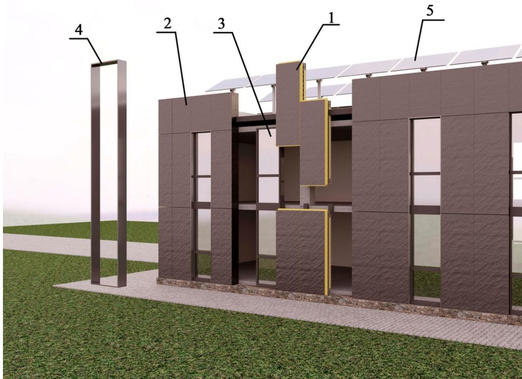
*Рис. 2.6. Схема поэлементного монтажа ограждающих конструкций здания*
