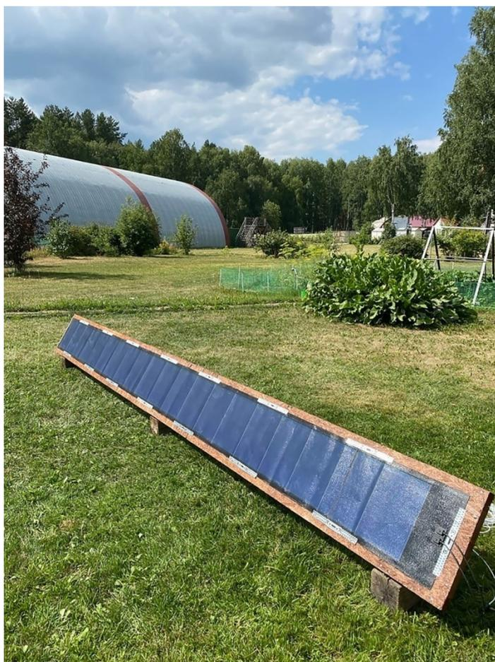
*Рис. 3.4. Установленная на наклонную подложку солнечная панель*
