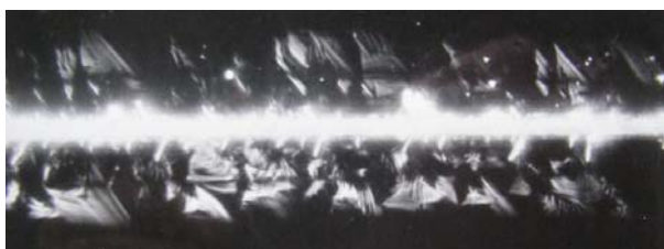
Рисунок 10 – Темнопольное изображение риски, нанесенной ребром пирамиды
