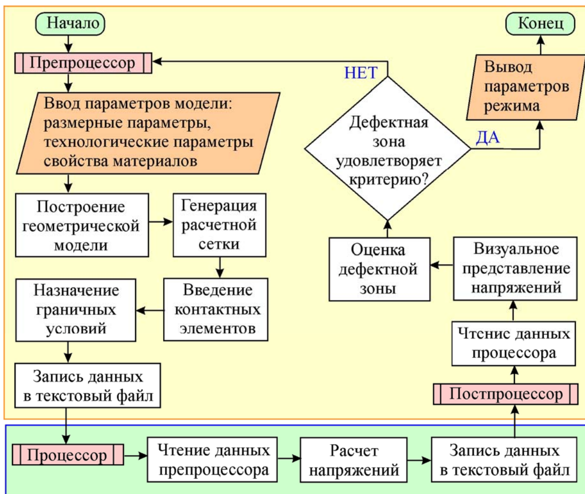
Рисунок 3 – Алгоритм компьютерного моделирования технологического процесса механической обработки средствами CAE
