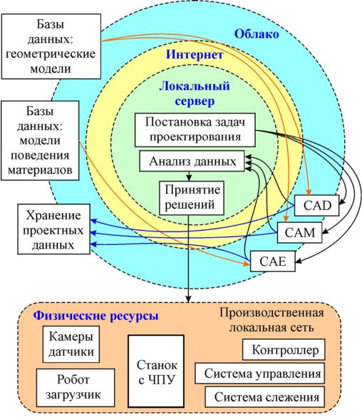
Рисунок 3.9 – Информационная схема облачной проектно-производственной системы
