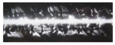
Рисунок 4.10 – Темнопольное изображение риски на поверхности кремниевой пластины
