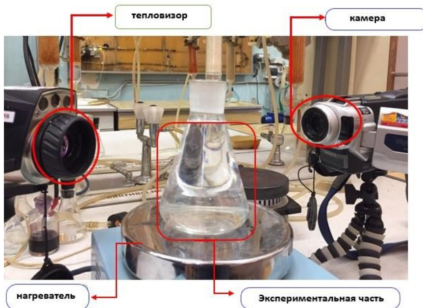
Рисунок 2.4. Экспериментальная установка для исследований низкочастотного воздействия на процесс вскипания перегретой жидкости
