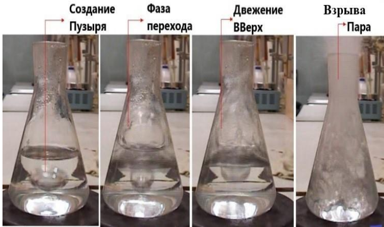
Рисунок 5.4. Фото процесса вскипания (взрыва) перегретой жидкости при t=108^{\circ}\text{C}
