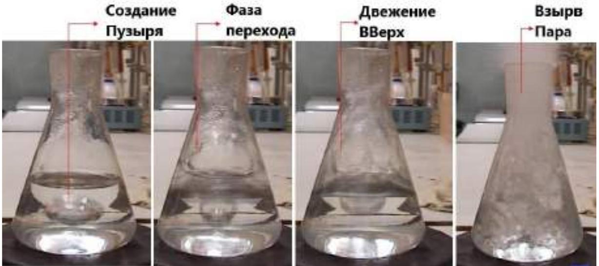
Рисунок 5.4 Процесс вскипания перегретой воды в результате кавитации, регистрируемый скоростной видеокамерой
