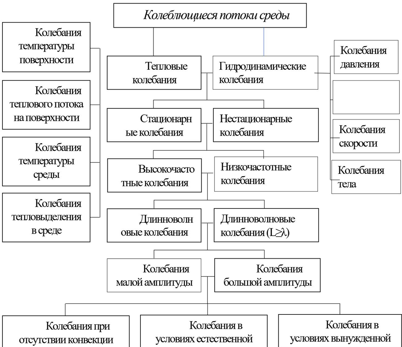
Рисунок 2.1 Структурная схема классификации колеблющихся потоков
