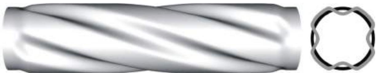
Рисунок П 4.3 Модель завихрителя с выравненным по площади проходного сечения поперечным профилем
