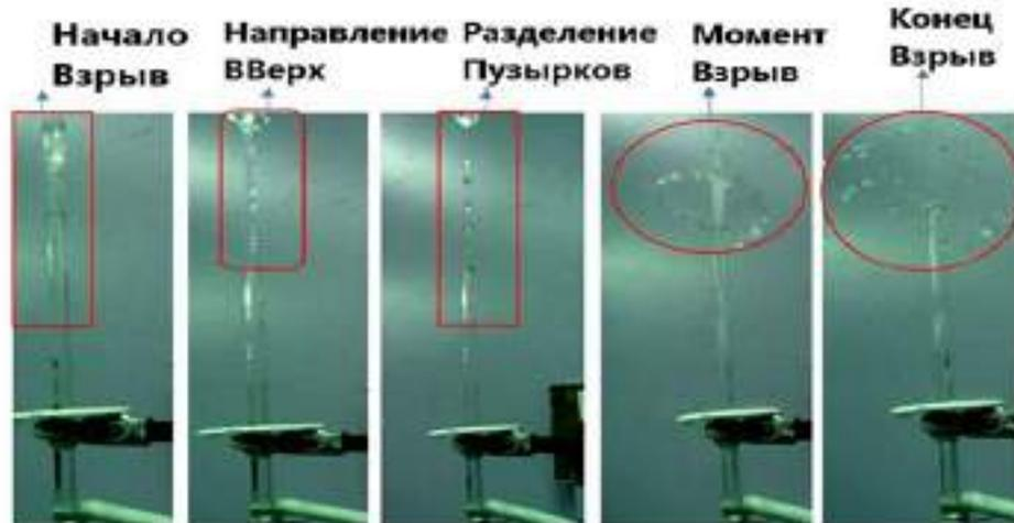
Рисунок 5.5 Фотофиксация взрыва в узком канале с перегретой жидкостью
