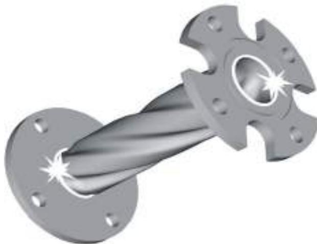
Рисунок П 4.8 Вид вставки-завихрителя после сварки фланцев и заготовки
