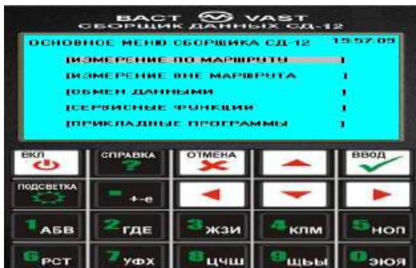
Рисунок П 1.8 Внешний вид панели управления виброанализатора СД-12М
