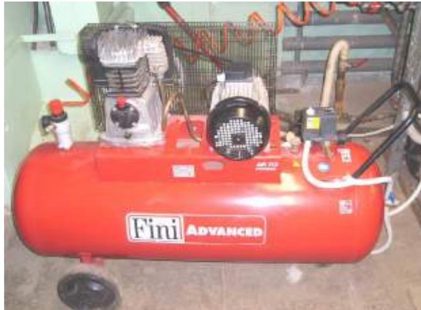
Рисунок П 1.2 Поршневой компрессор
