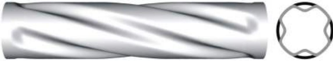
Рисунок П 4.2 Поперечный профиль и продольный вид неоптимизированной вставки
