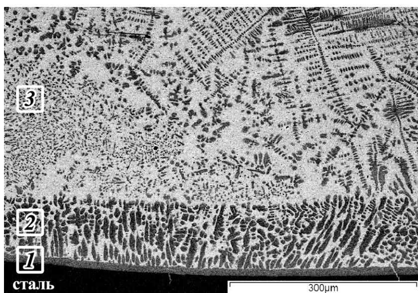
Рисунок 15 – Микроструктура наплавленного слоя бронзы БрЖНА 12-7-1 на стальное основание
