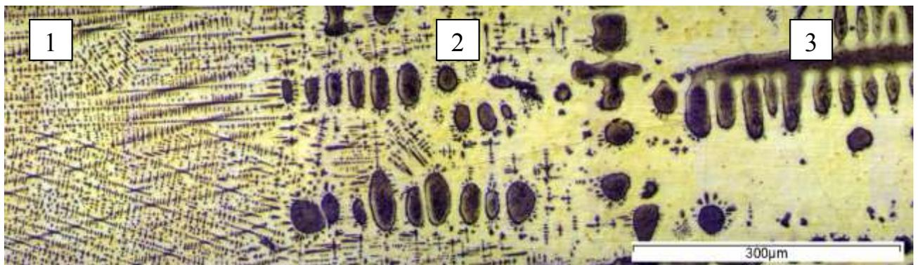
Рисунок 5.1 – Структура бронзы типа БрЖНКоА: 1 - переплавленный слой;
