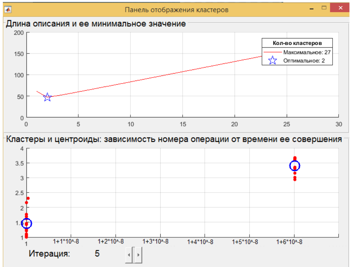
Рисунок 3.3. Расчет оптимального количества кластеров k и построение центроидов и скоплений точек
