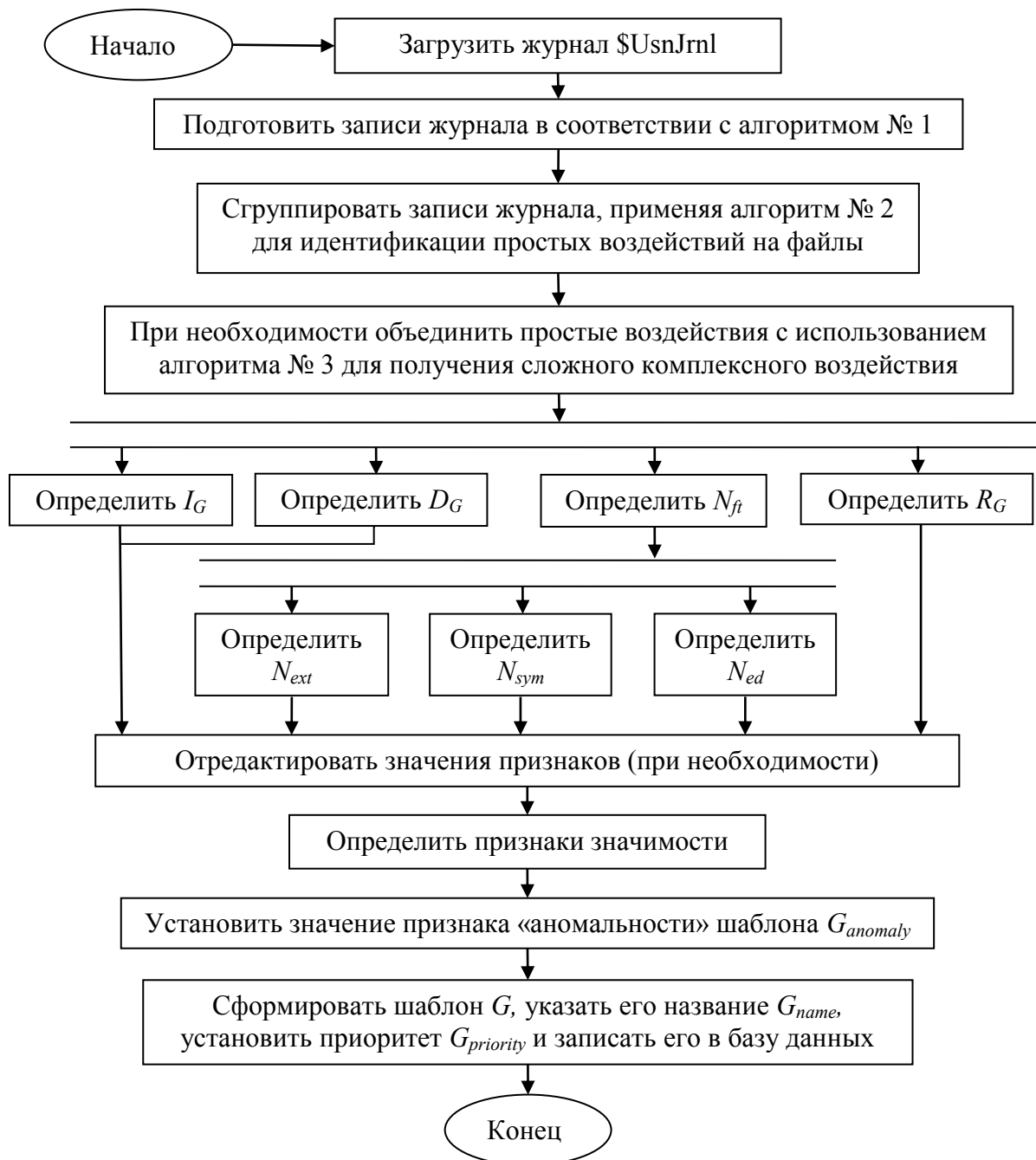
Рисунок 2.9. Блок-схема алгоритма генерации шаблона воздействия на файл
