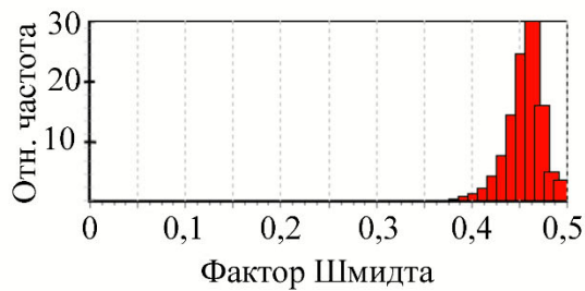
Рисунок 4.17 – Карты фактора Шмидта (а, в) и гистограммы фактора Шмидта (б, г) в сплавах Fe-12%Mn-1,1%C (а–б) и Fe-25%Mn-2,2%C (в–г), закристаллизованных до и после разрушения микрогетерогенного состояния расплава.
