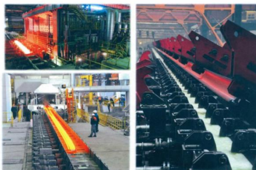
Рисунок 1.8 – Рельсобалочный стан на Челябинском металлургическом комбинате (ЧМК)
