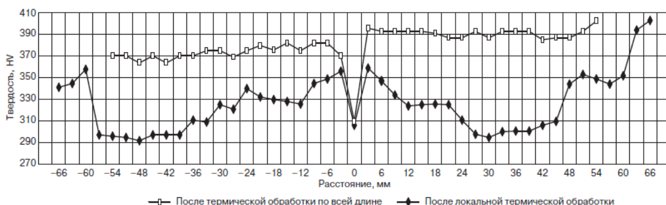
Рисунок 1.30 – Распределение твердости в зоне сварного шва [100]
