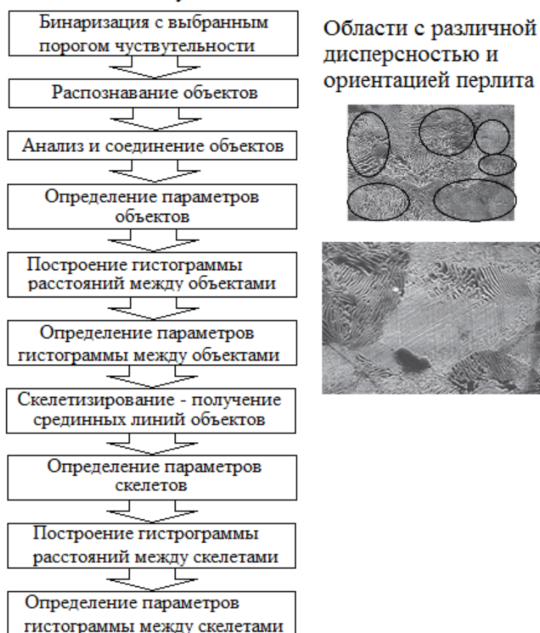
Рисунок 3.22 – Алгоритм обработки микроструктур перлита для получения распределения структур перлита по межпластинчатому расстоянию
