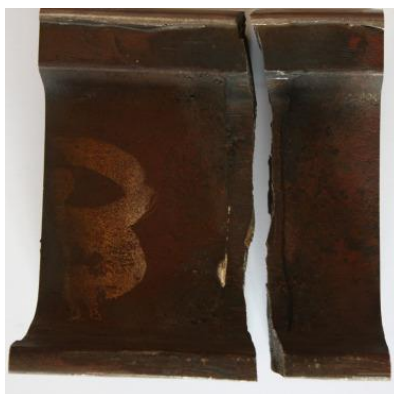
Рисунок 4.1 – Положение трещины рельса в ЗТВ стыка и форма распространения трещины по всему сечению [248]
