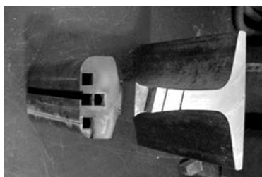
Рисунок 2.2 – Визуализация факта вырезки образцов для механических свойств по длине сварного стыка
