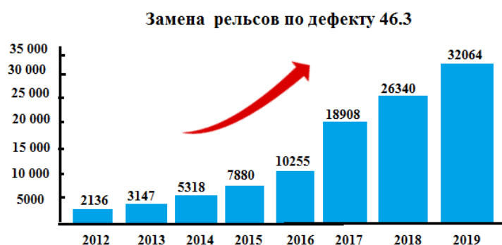
Рисунок 1.3 – Выход рельсов по дефектам сварных стыков (Код дефекта рельса 46.3 – Смятие и износ головки в зоне сварного стыка из-за местного снижения механических свойств металла после пропуска гарантийного тоннажа )
