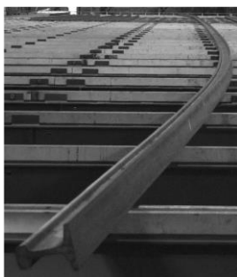
Рисунок 1.15 – Искривление рельсов после термической закалки
