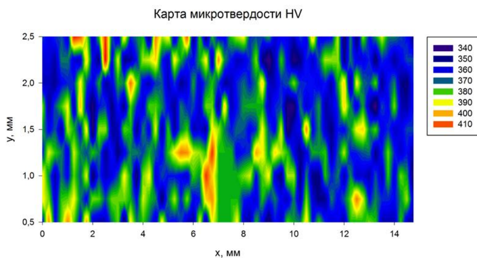
Рисунок 4.24 – Картирование микротвердости в площади линия сплавления
