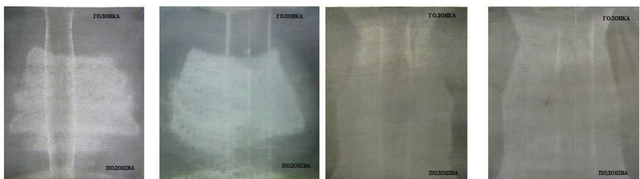
Рисунок 1.36 – Дефекты термообработки сварного стыка, выявляемые только
