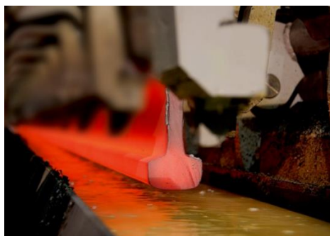
Рисунок 1.9 – Дифференцированная закалка рельсов в растворе полимера на Челябинском металлургическом комбинате (ЧМК)
