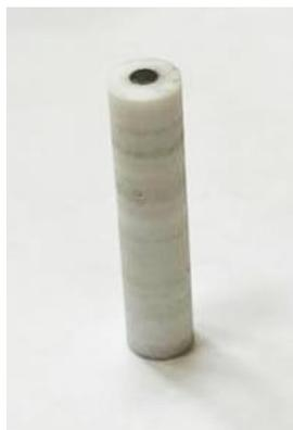
Рисунок 5.3 – Титановый катод в изолирующей оболочке
