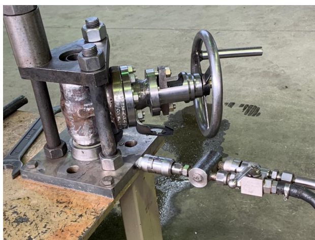
Рисунок 5.19 –Проведение гидравлических испытаний задвижки с изготовленным клином на герметичность (протечки)
