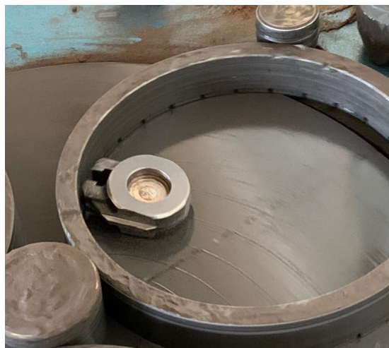
Рисунок 5.18 – Заготовка клина после тонкого фрезерования (а) и общий вид процесса притирки клина (б).
