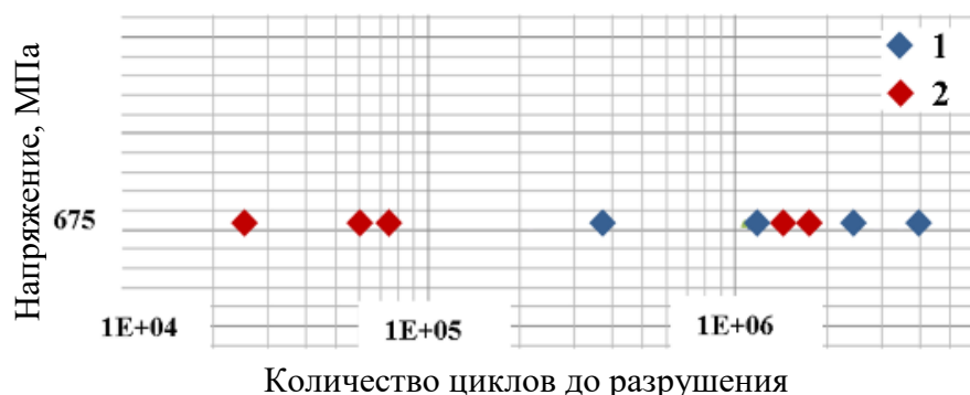
Рис. 11 – Результаты усталостных испытаний образцов: 1) первичный порошок; 2) многократно использованный порошок
