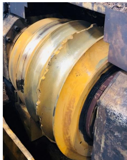
Рис. 2. Вид изношенной поверхности в зоне скрещивания
