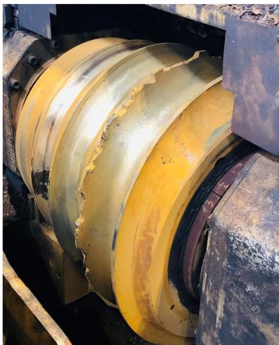
Рисунок 9. Вид изношенной поверхности и разрушения реборды в зоне скрещивания валков
