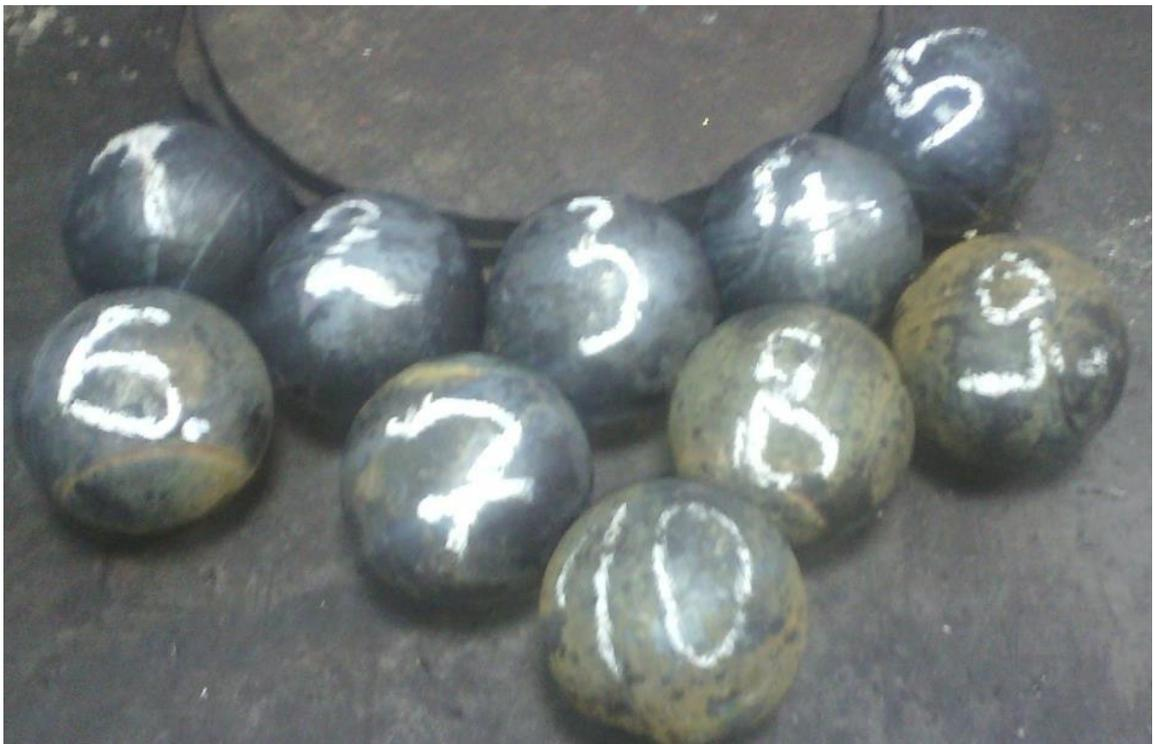
Рисунок 61. Партия шаров условным диаметром 60 мм с разными режимами закатки и самоотпуска
