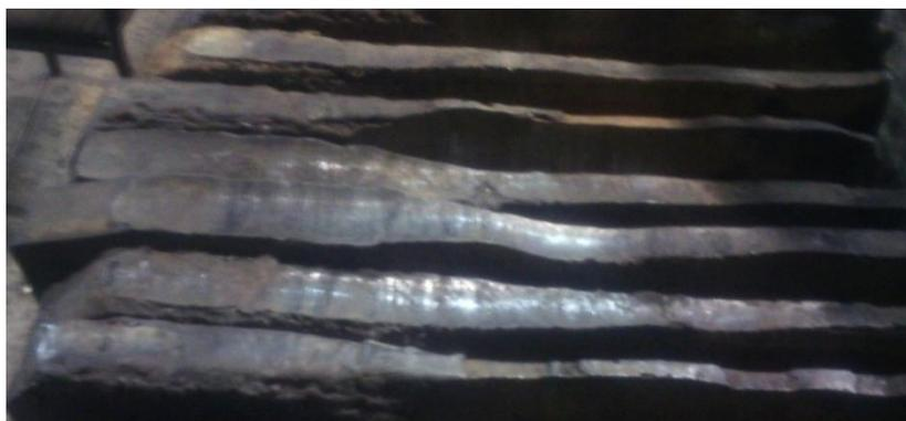
Рисунок 11. Вид изношенной поверхности проводок шаропрокатного стана
