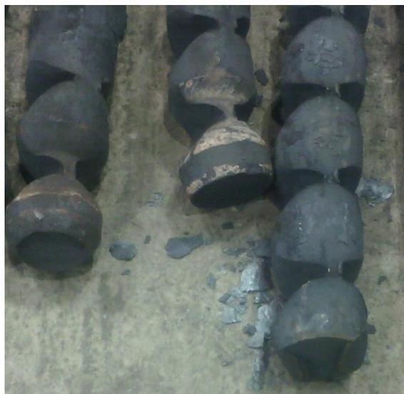
Рисунок 8. «Рейка», недокат, образующийся при отсутствии вращения заготовки
