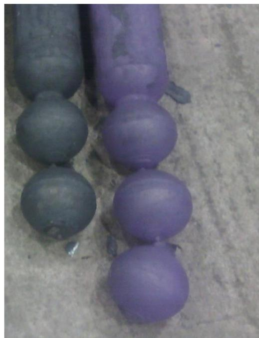
Рисунок 10. «Гирлянда» - недокат, образованный при отсутствии удаления перемычки
