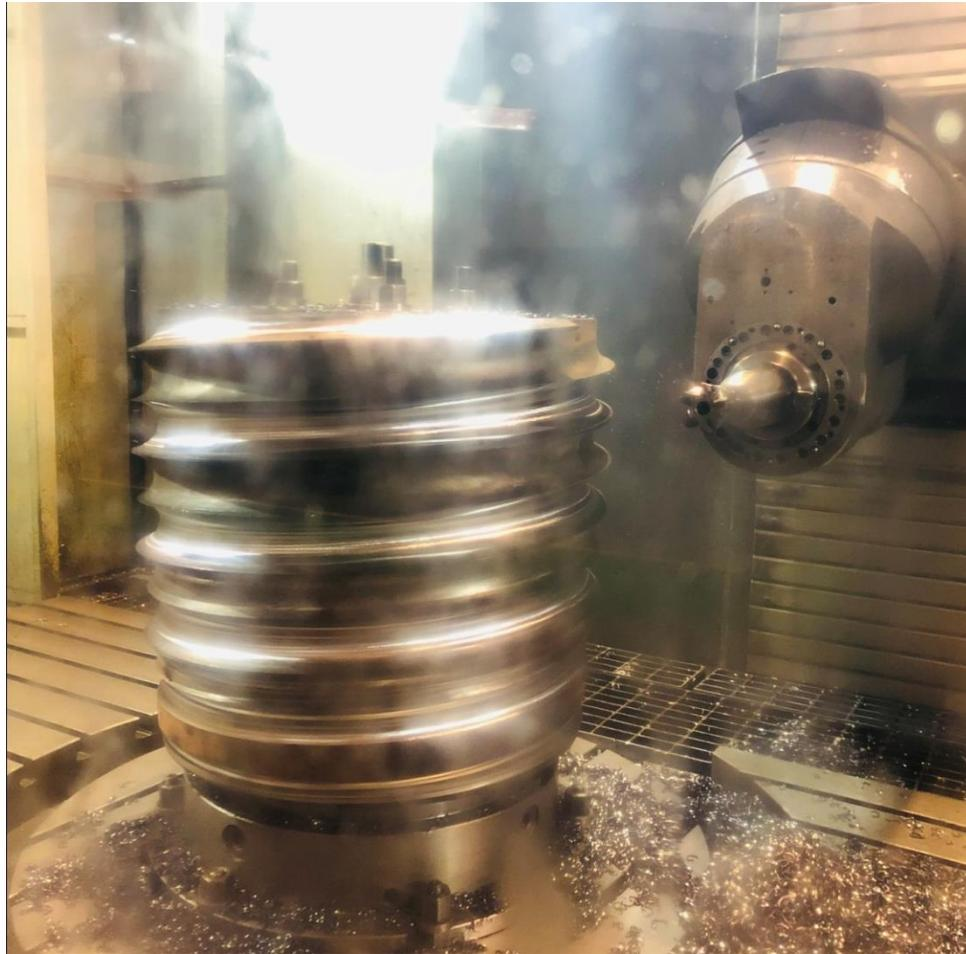
Рисунок 5. Изготовление шаропрокатных валков на 5-координатном обрабатывающем центре.
