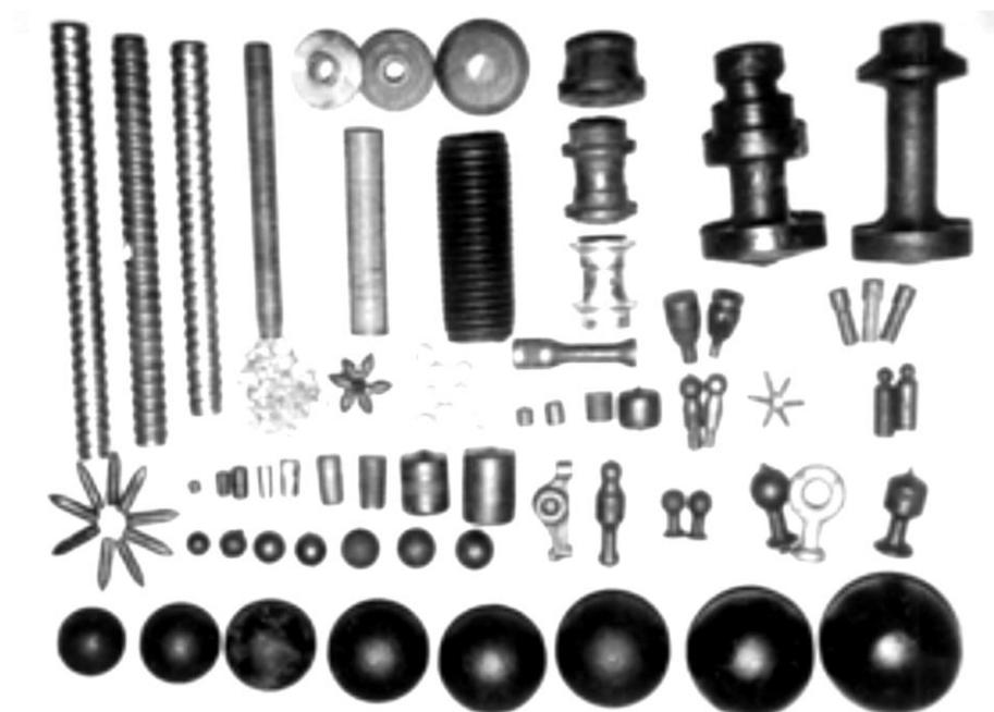
Рисунок 2. Сортамент, получаемый поперечно-винтовой прокаткой [29]
