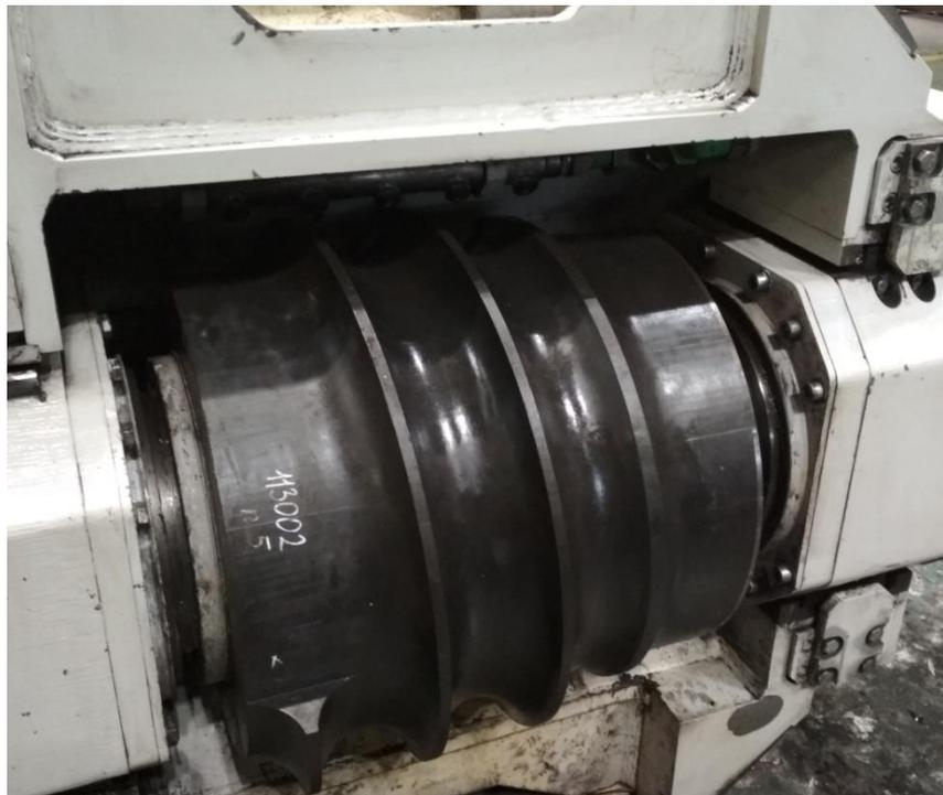
Рисунок 43. Валок с постоянной шириной реборды и непрерывно-меняющимся шагом
