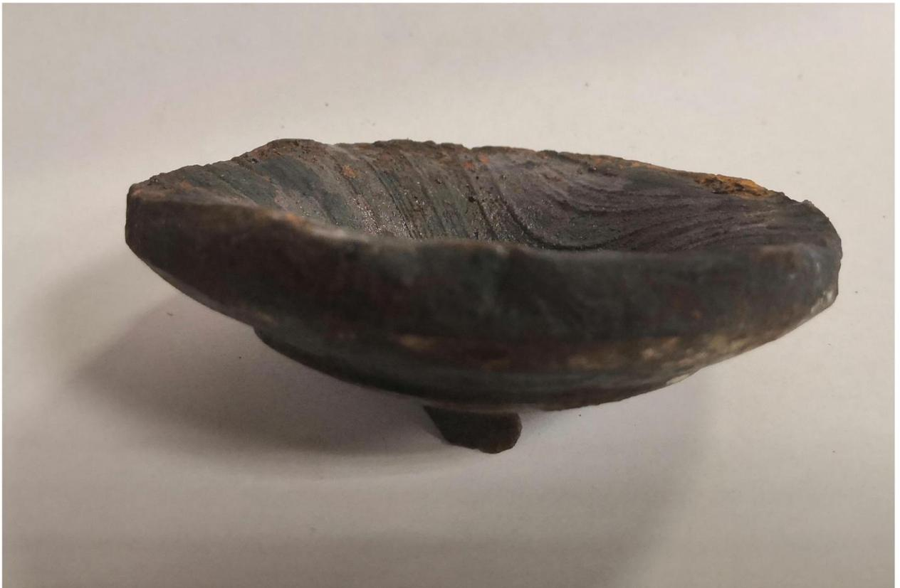
Рисунок 49. Половинка, полученная при опытной прокатке
