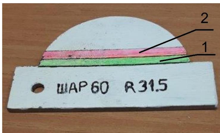
Рисунок 23. Шаблон для контроля глубины износа реборд валков
