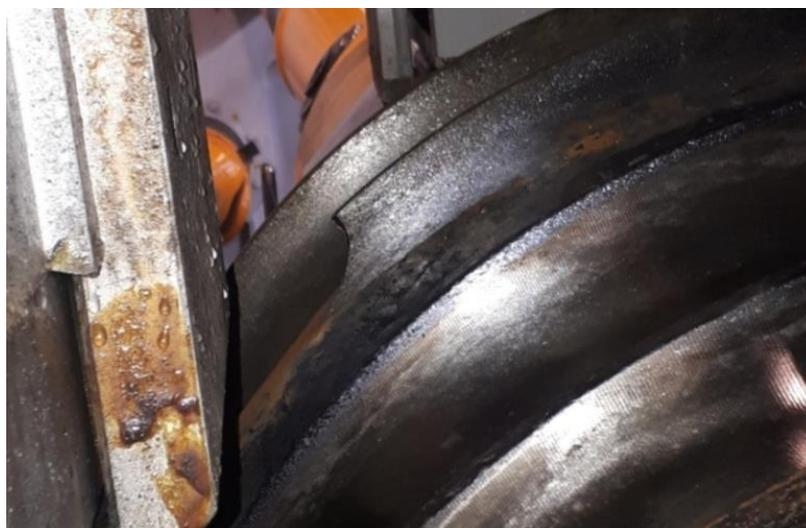
Рисунок 12. Разрушение реборды валка в зоне отделения перемычки
