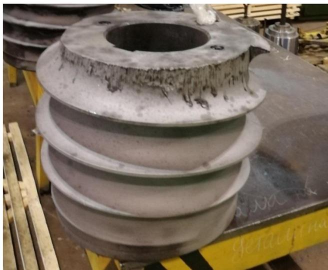
Рисунок 35. Шаропрокатный валок для производства шаров условным диаметром 60 мм, с дискретно-изменяющимся шагом и развалкой
