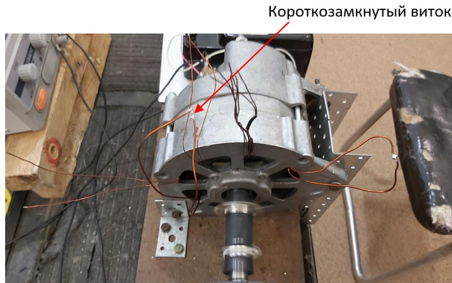
Рис.4.3.2. Формирование короткозамкнутого витка якорной обмотки
