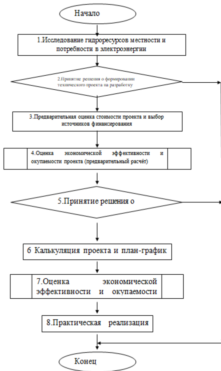
Рис.1.2.1. Алгоритм разработки и реализации проекта энергоснабжения на базе мини-ГЭС
