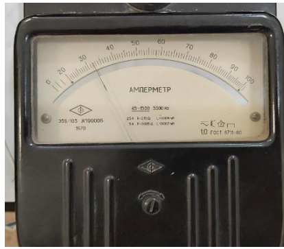
Рис.4.3.3. Показания амперметра при коротком замыкании 1 витка
