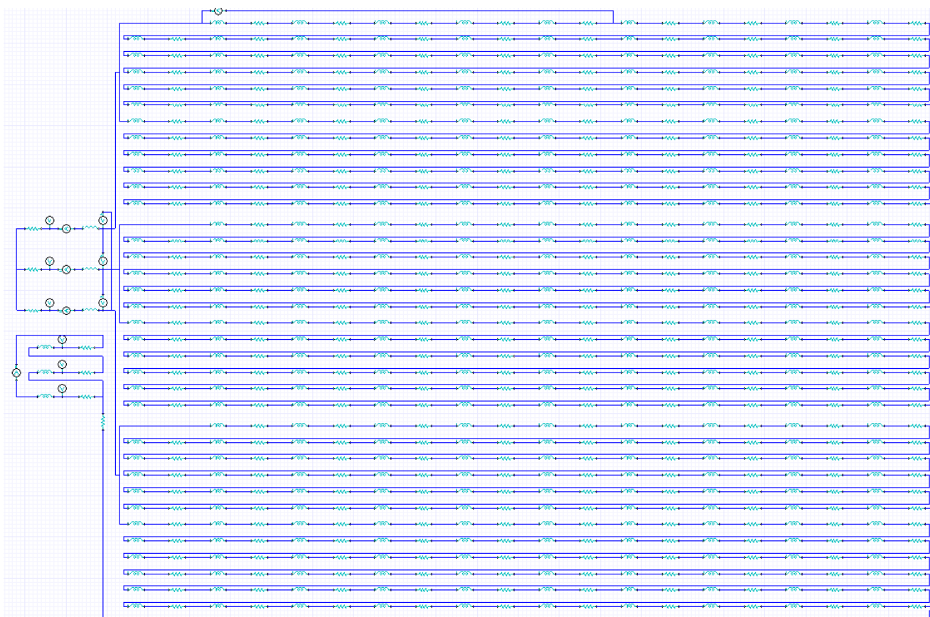
Рис.2.4.1. Схема тестирования генератора при к.з. 5 витков для информационной обмотки, соединенной в треугольник.
