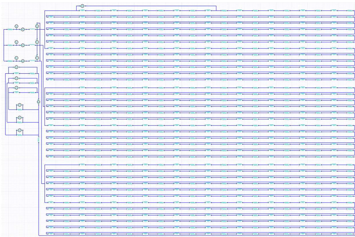
Рис. 2.4.6. Схема тестирования режима короткого замыкания 5-ти витков при информационной обмотке, соединенной в звезду
