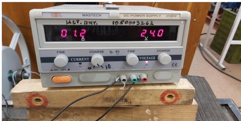
Рис.4.2.4. Питание цепи возбуждения генератора источником постоянного тока
