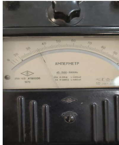
Рис.4.3.4. Показания амперметра при коротком замыкании 3 витков
