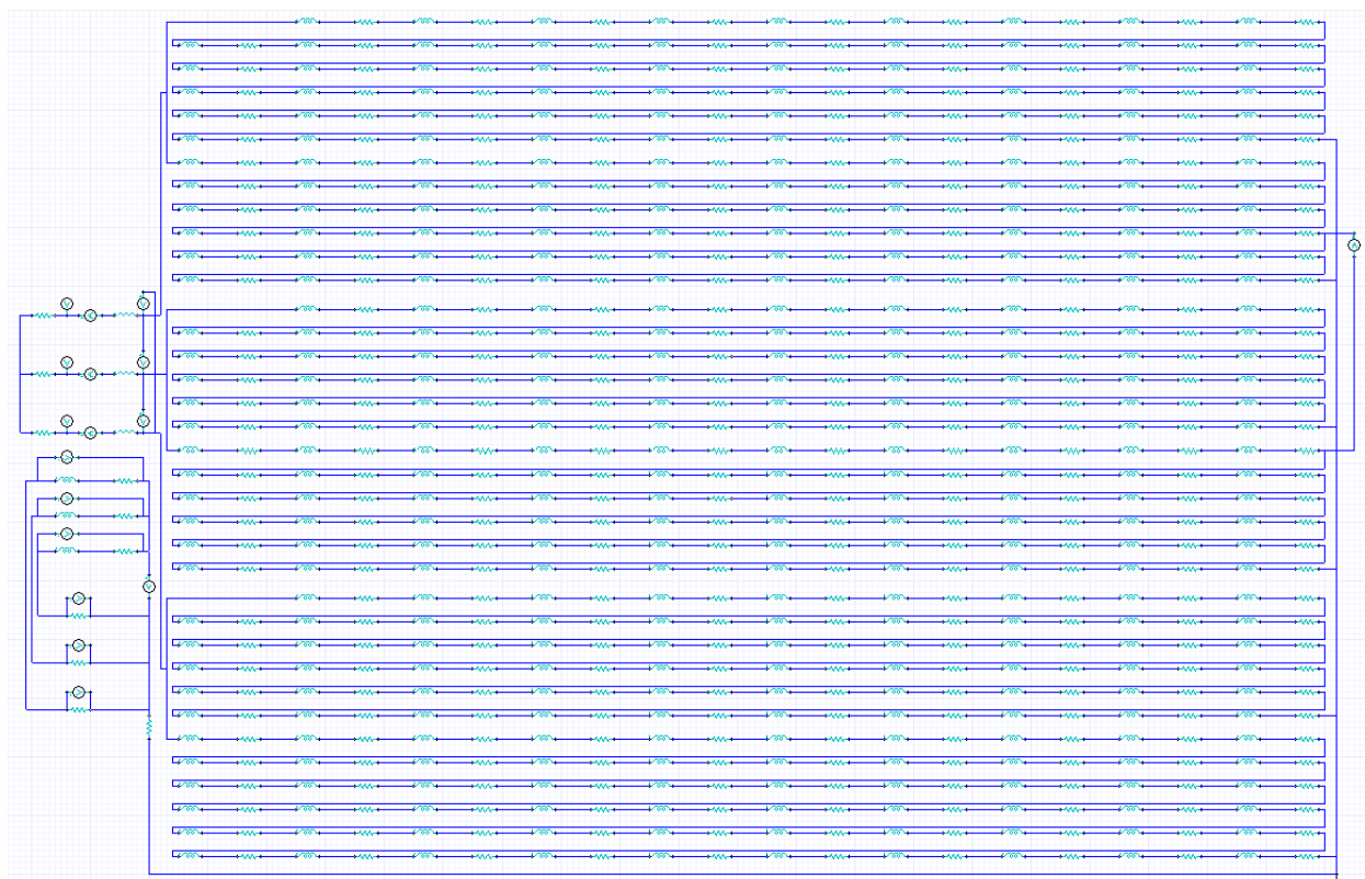
Рис.2.6.1. Испытательная схема при исследовании межфазного виткового короткого замыкания
