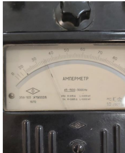
Рис.4.3.5. Показания амперметра при коротком замыкании 5 витков
