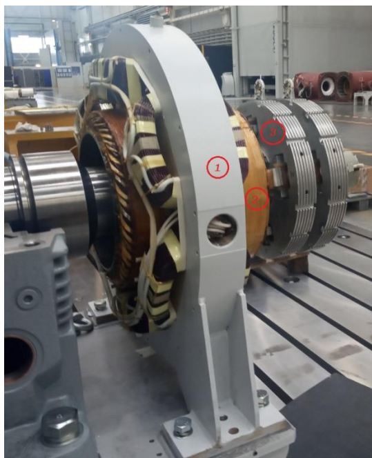
Рис. 1.2.1.1. Конструкция БВУ: 1 – статор, 2 – ротор, 3 – вращающийся выпрямитель
