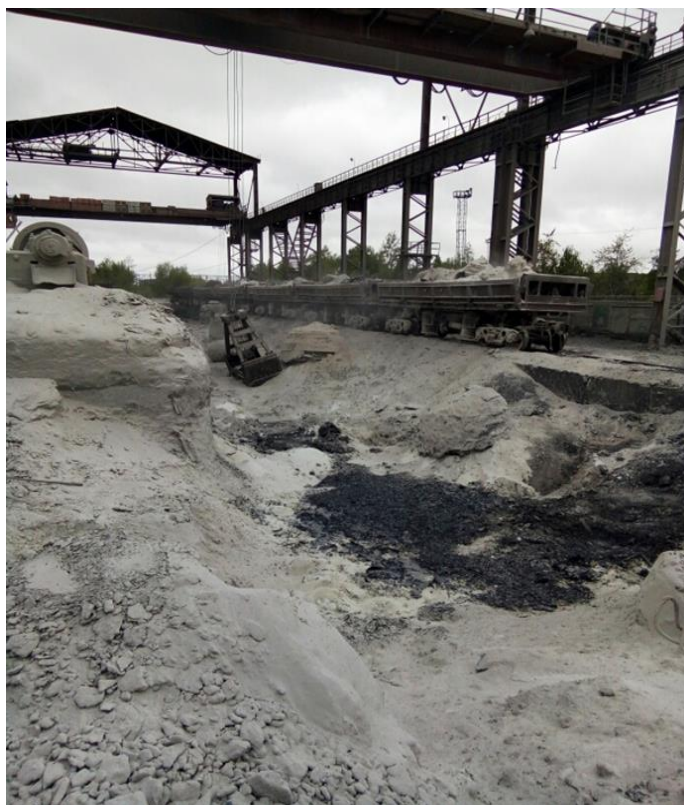
Рисунок 11 – Погрузка шлака ВОС со шлакового двора конвертерного цеха АО «ЕВРАЗ НТМК» в ж/д транспорт перед отправкой в ОАО «ВГОК»
