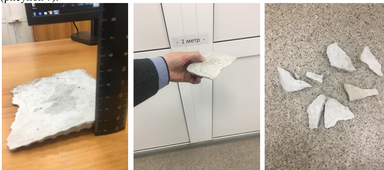
Рисунок 7 - Испытание камневидного тела шлака ВОС на сбрасывание
