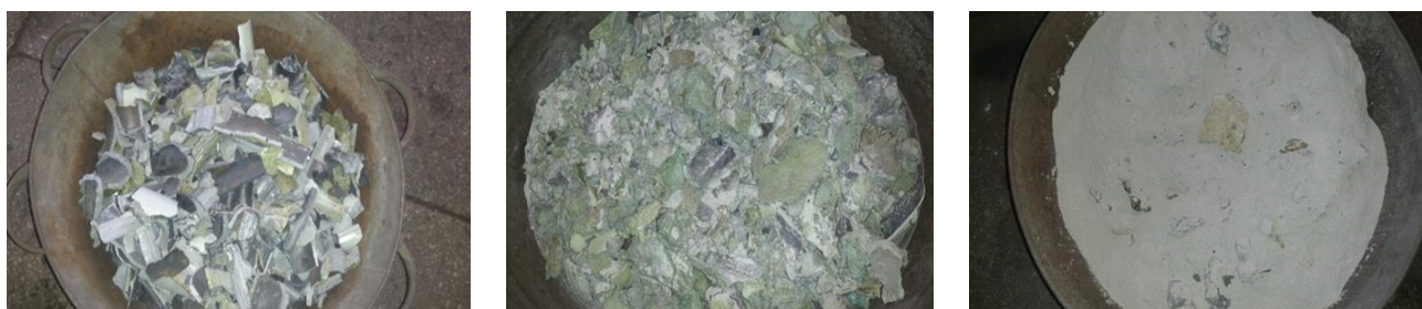
а - стабилизированный; б - частично распавшийся; в - распавшийся Рисунок 10 - Образцы шлаков
