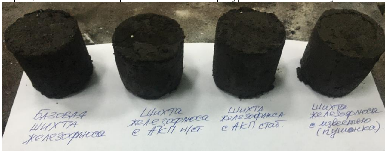
Рисунок 8 - Образцы шихты железофлюса с различными вяжущими
