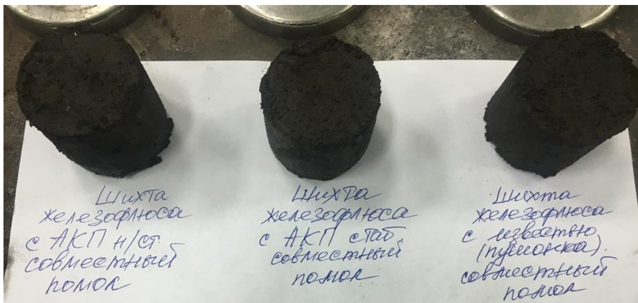
Рисунок 9 - Образцы аглошихты при совместном помоле с различными вяжущими
