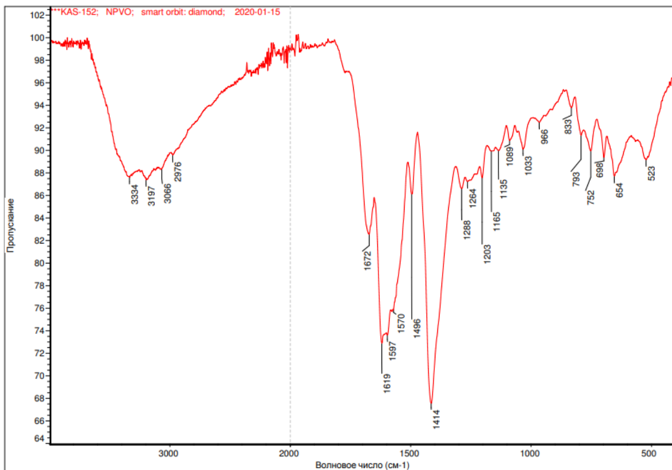
Рисунок 6.8 – ИК-спектр пробы, полученный из MNB без экстракционной очистки.
